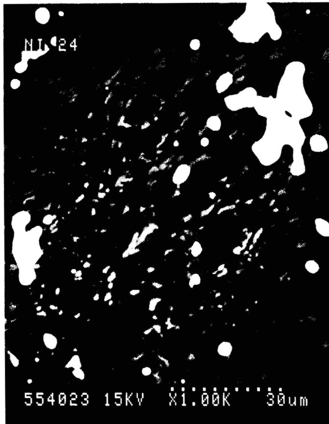
Photo 2: Micrographie MEB d'un composite alumine-nickel à 8,72 vol.% de nickel ( x 1000 électrons rétrodiffusés)
