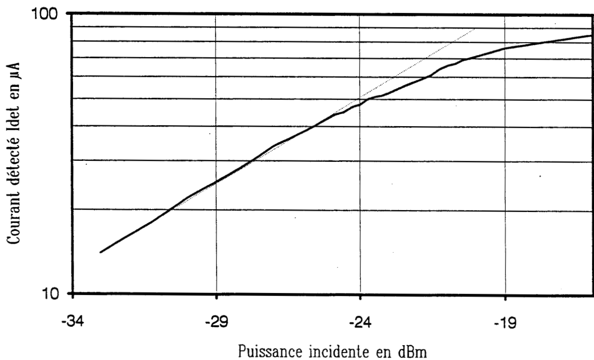
Figure 3.10 : Evolution du courant détecté fonction de la puissance incidente pour un échantillon GaAs/GaAlAs polarisé à la tension pic.
