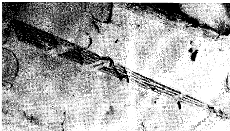
Figure IV-47: macle du Brésil d'origine mécanique (barre d'échelle 0,5 \mu m).
