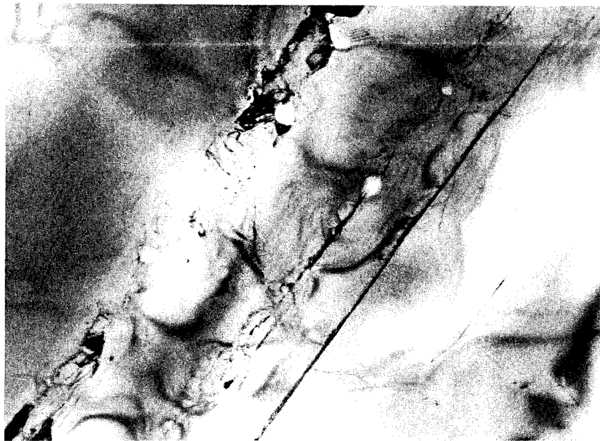
Figure IV-8: micrographie électronique en champ clair du même grain. On observe des PDF ainsi que quelques bulles (barre d'échelle 1 \mu m).
