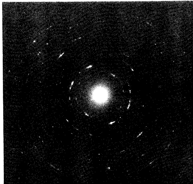
Figure IV-46: Diagramme de poudre correspondant, effectué sur ces petits grains. Les distances mesurées sont celles du quartz.
