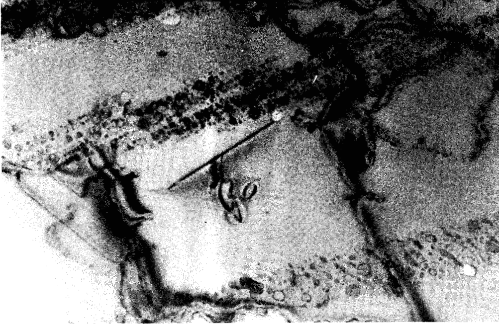
Figure IV-51: Lorsque l'on fait un agrandissement de l'un de ces PDF, on se rend compte qu'il est constitué d'un grand nombre de très petites bulles alignées selon une direction. De même, de très petites bulles ont précipité sur les dislocations d'origine tectonique (barre d'échelle 0,5 \mu m).
