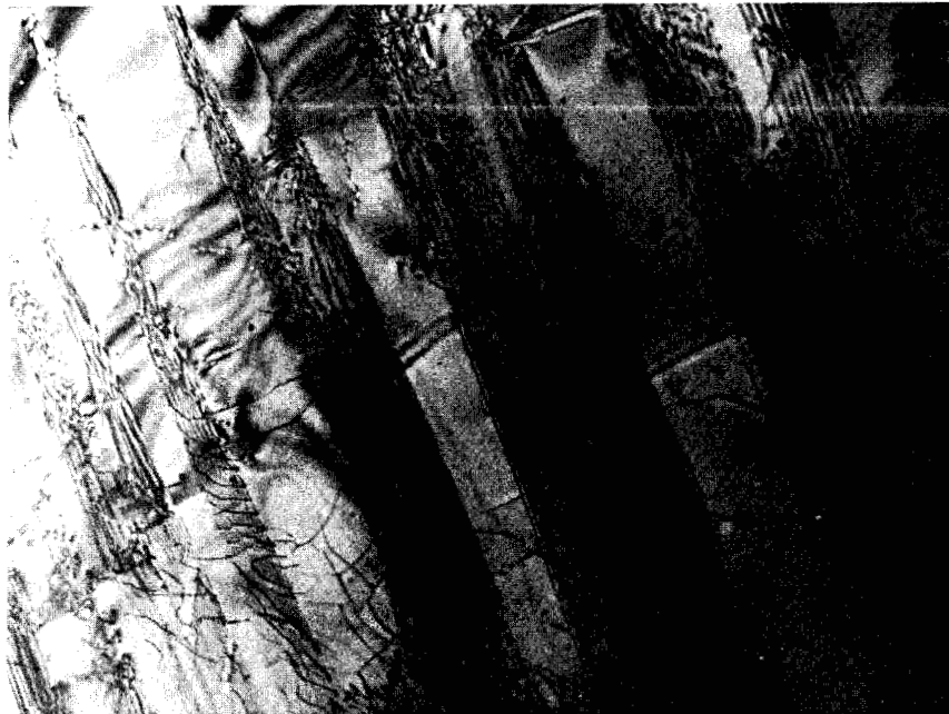
Figure IV-4: vue générale en MET (champ clair) du même grain que ci-dessus. On observe un grand nombre de macles mécaniques (barre d'échelle 1 \mu m).
