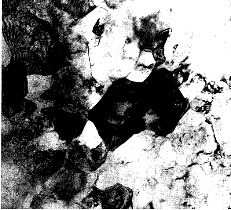
Figure IV-43: Au MET, on détecte des grains de taille moyenne ( \approx 1\mu\text{m} ) (barre d'échelle 1\mu\text{m} ).
