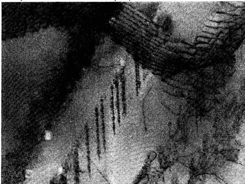
Figure IV-52: Dans un autre grain, on observe également cette fine précipitation, ainsi qu'un sous-joint (barre d'échelle 0,5 \mu m).
