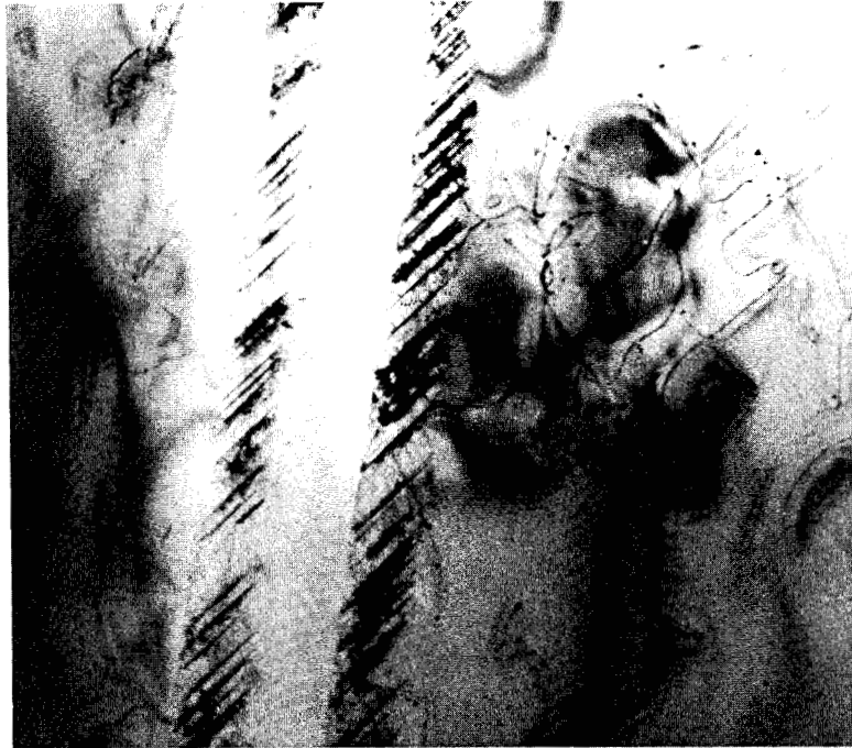
Figure IV-31: défaut "en échelon" vu en champ clair (barre d'échelle 1\mu\text{m} ).
