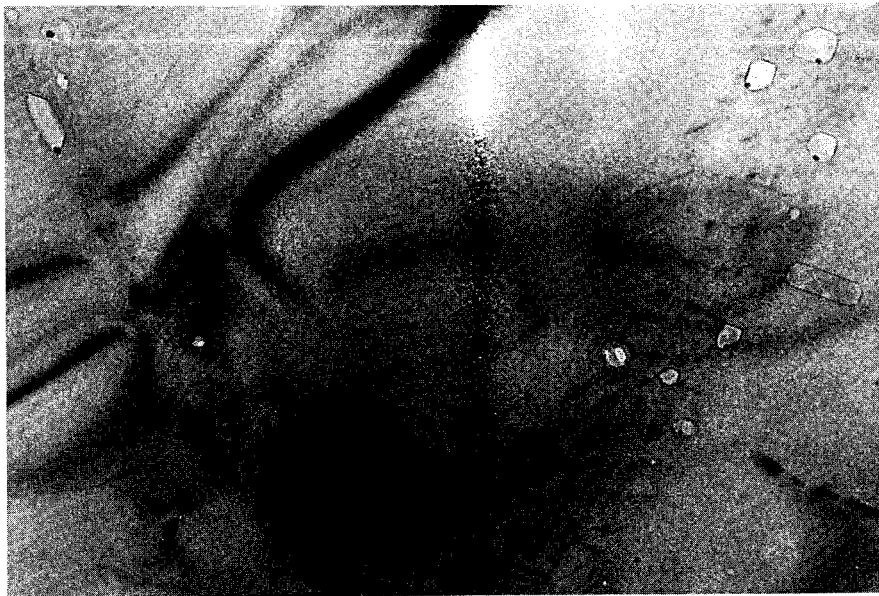
Figure IV-18: sous-joint et PDF décorés de très petites bulles. Dans ces bulles, une phase solide a précipité (points noirs) (barre d'échelle 0,5\mu\text{m} ).
