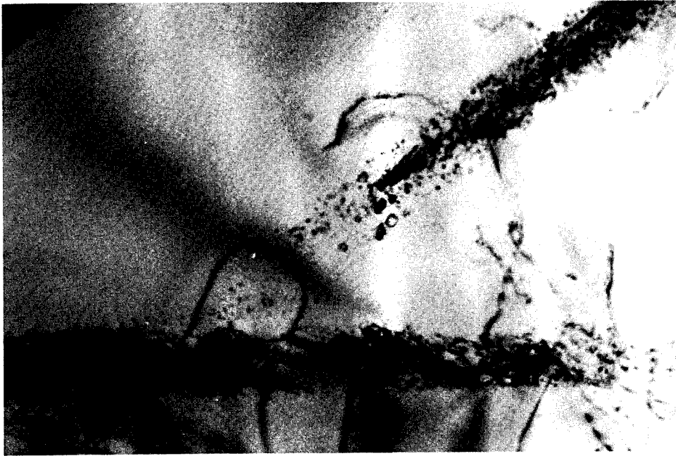
Figure IV-13: agrandissement d'une extrémité d'un des défauts de la micrographie précédente. De petites boucles de dislocations sont visibles (barre d'échelle 0,5 \mu m).
