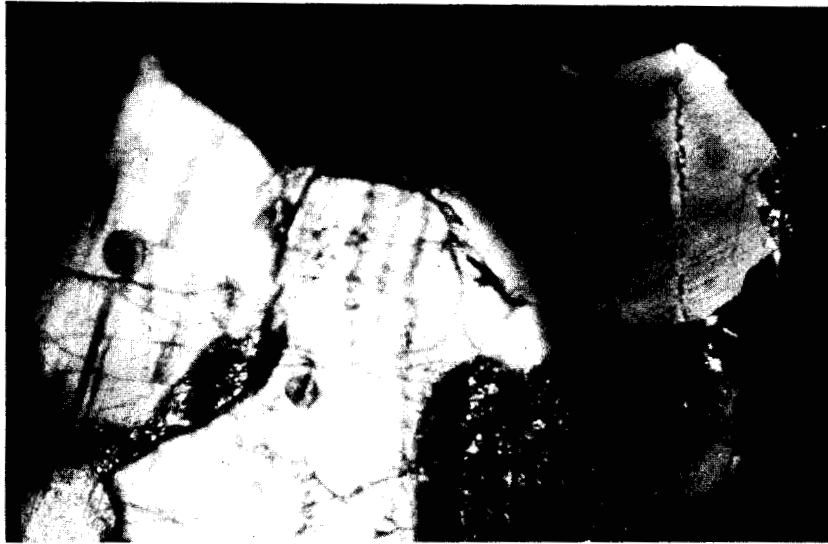
Figure IV-3: micrographie optique en lumière naturelle du même grain que IV-2 après amincissement (barre d'échelle 100 \mu m).
