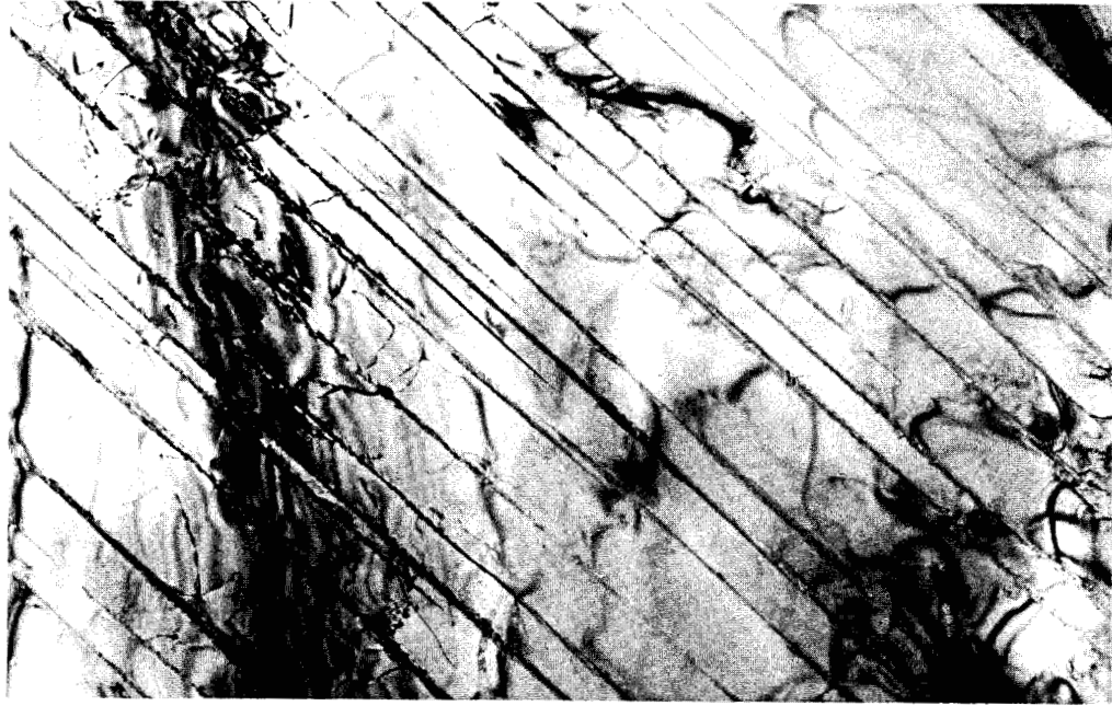
Figure IV-23: micrographie électronique (champ clair) de la même zone. On observe une grande densité de PDF. Ils sont "de bout" (barre d'échelle 1 \mu m).
