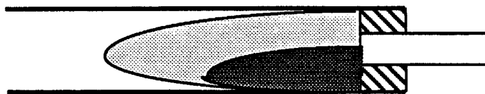
Fig.B27: Représentation schématique du nuage de traceur (effet de densité) à l'entrée du tube inférieur.
