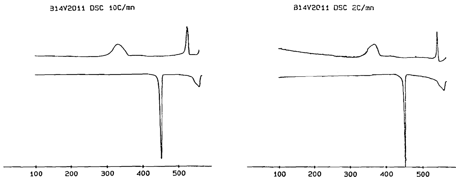
Figure I. 8. Courbes de DSC obtenues entre 25 et 570°C sur \text{Bi}_4\text{V}_2\text{O}_{11} à 10°C/mn (à gauche) et 2°C/mn (à droite)
