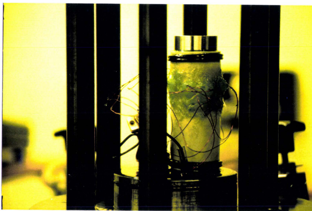
Photo 2.1 : Gaine silicone et passage des fils de jauges d'extensométrie
