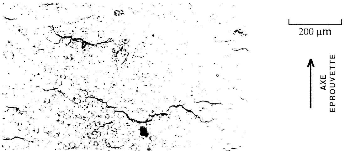
Figure IV-9 Photographie de la surface de l'éprouvette d'acier à 0,4 % C à 6600 cycles pour \Delta\sigma = 960 MPa.
