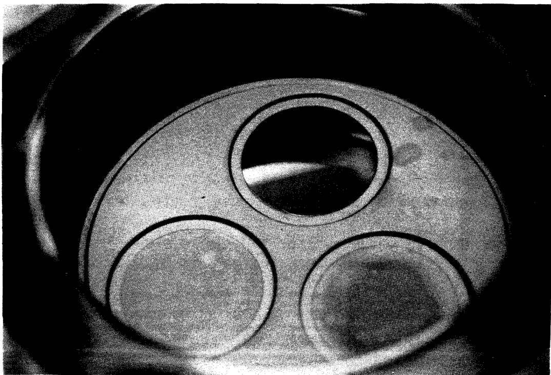
Fig 7 : photographie du réacteur ouvert, après épitaxie d'une couche d'AlInAs, d'aspect miroir, sur un substrat InP placé sur l'un des trois suscepteurs. Les deux autres sont protégés par des "caches" en silicium où le dépôt est polycristallin.
