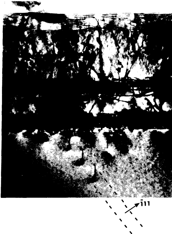
Figure V. 13: Structure M_2 ; champ clair g = \bar{2}20 . Empilement ( \bar{1}11 ) de dislocations de vecteur de Burgers 1/2[01\bar{1}]
