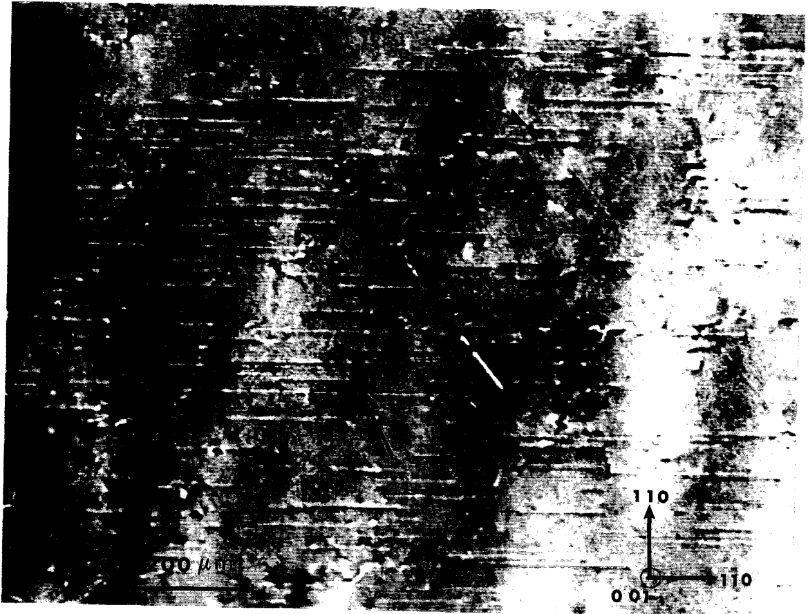
Figure III.6.: Topographie aux rayons X en réflexion de l'échantillon A; g = \bar{2}\bar{2}4 .
