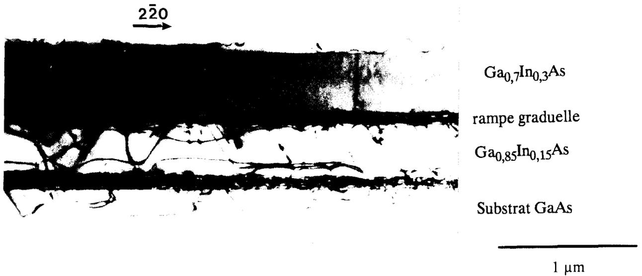
**Figure II.42:** Cliché de microscopie électronique en transmission de l'épitaxie 910608 amincie par la tranche.
