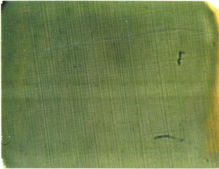
Figure II.28: Photographie au microscope optique de la surface de l'épitaxie 910120: mise en évidence du "cross hatching".
