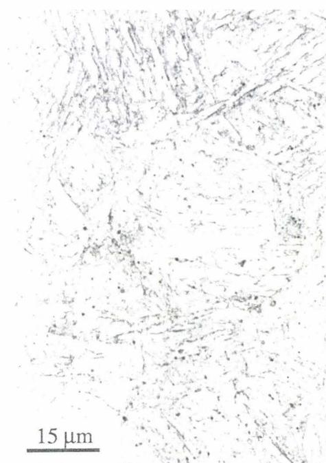
*Figure IV-2: microstructure de l'acier M1 austénitisé 30' à 1150°C.*
