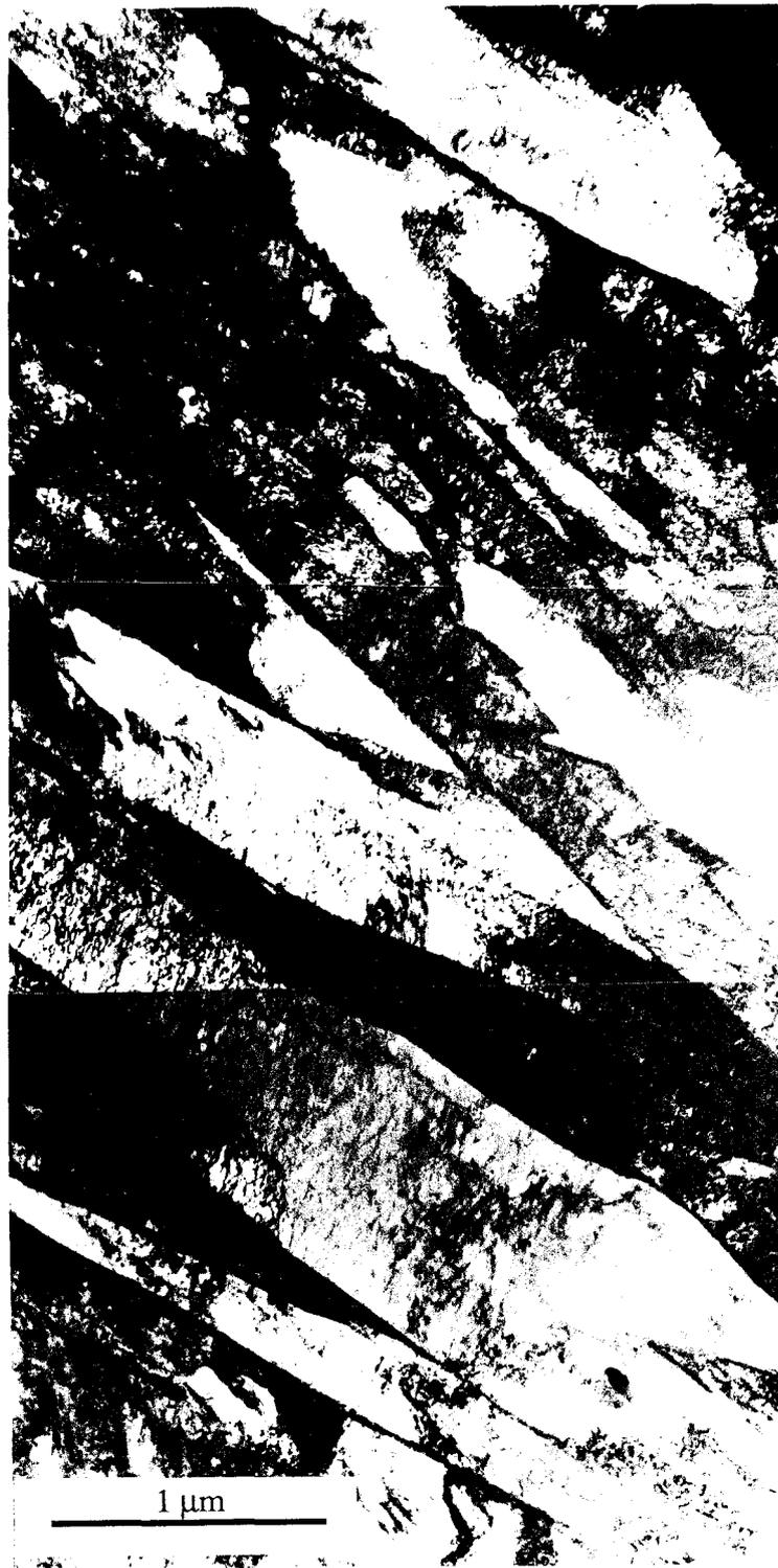
*Figure IV-4-b: structure martensitique en lattes de l'acier M2 austénitisé 30 minutes à 1150°C.*
