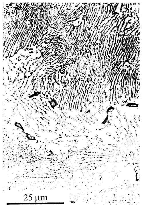
Figure III-20: aspect de la précipitation de la phase  $\sigma$  dans l'échantillon vieilli 150 heures à 800°C.
