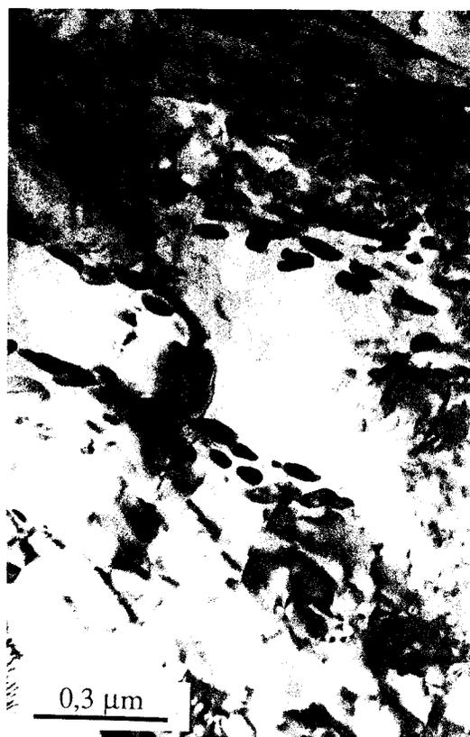
Figure V-12: aspect de la précipitation de  $Cr_2(C,N)$  dans les joints de lattes des échantillons vieillis 1 heure à 700°C - a) acier M1 b) acier M2
