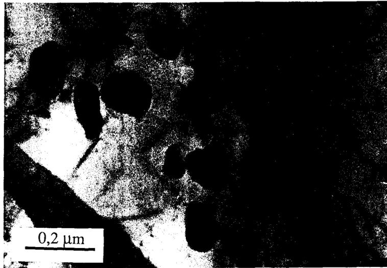
Figure V-13: précipités de type  $Cr_2(C,N)$  dans l'acier M1 vieilli 1 heure à  $800^\circ C$ .
