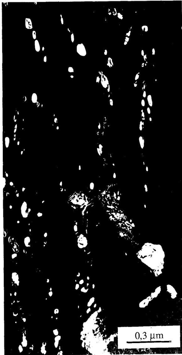
*Figure V-23: carbonitrides  $Cr_2(C,N)$  issus de la décomposition de l'austénite retenue dans l'acier M1 vieilli 1 heure à 700°C.*
