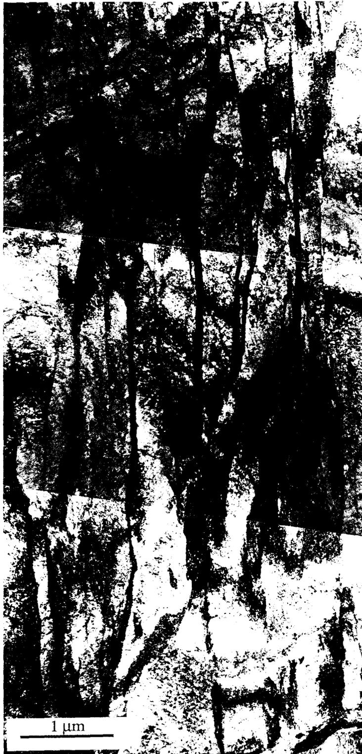
*Figure IV-4-a: structure martensitique en lattes de l'acier M1 austénitisé 30 minutes à 1150°C.*
