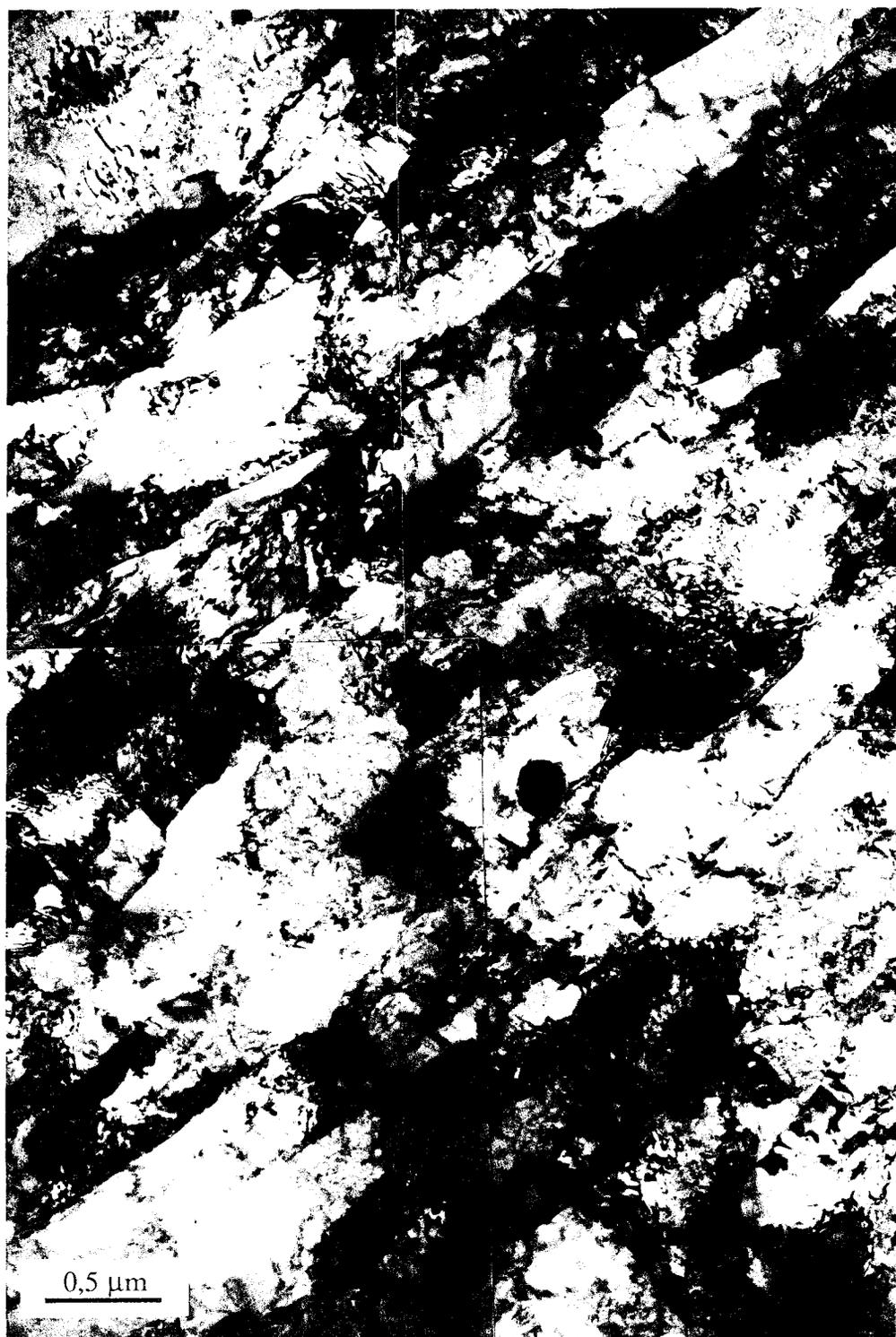
*Figure V-25: aspect général de la microstructure de l'acier M1 après un traitement thermique de 1 heure à 700°C.*
