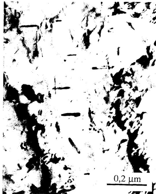
Figure V-14: aspect de la précipitation intralatte de nitrures de type  $Cr_2N$  dans les échantillons vieillis 1 heure à  $700^\circ C$
