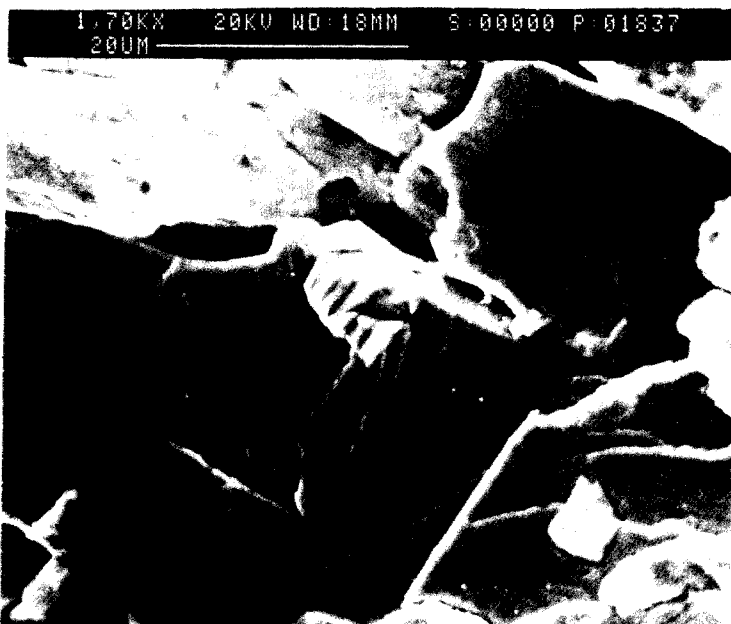
a/ Selle de cheval ; milieu primaire hydrogéné (1 bar à 125°C) à 360°C ; 500 h
