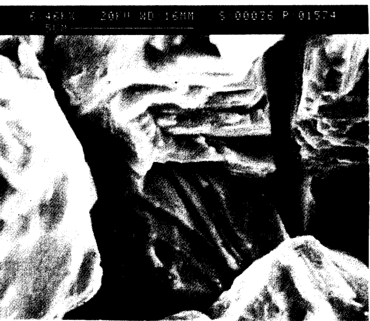
c/ Essai à contrainte imposée 570 MPa ; milieu primaire hydrogéné (4 bar à 125°C) à 360°C
