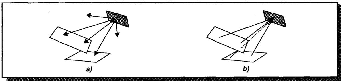
Figure 5.21 Calcul de l'éclairage par les méthodes stochastique (a) et déterministe (b)
