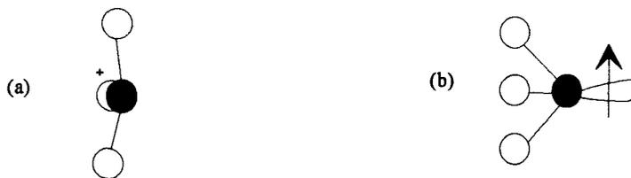
**Figure II-9 :** Diagramme schématique des deux états de charge associés au centre  $E'_s$  (a) chargé positivement et invisible par RPE (b) neutre et actif par RPE [28].
