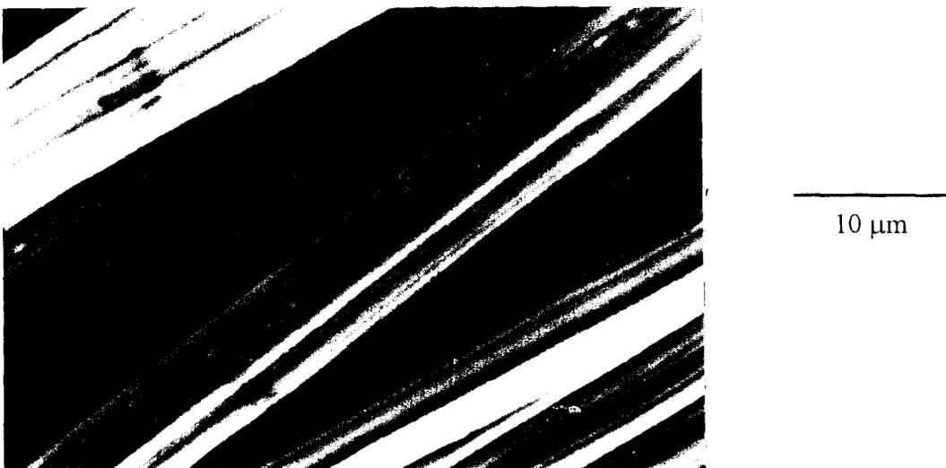
*Figure VII-2:* Aspect de la précipitation préférentielle des nodules intermétalliques le long d'une génératrice du filament
