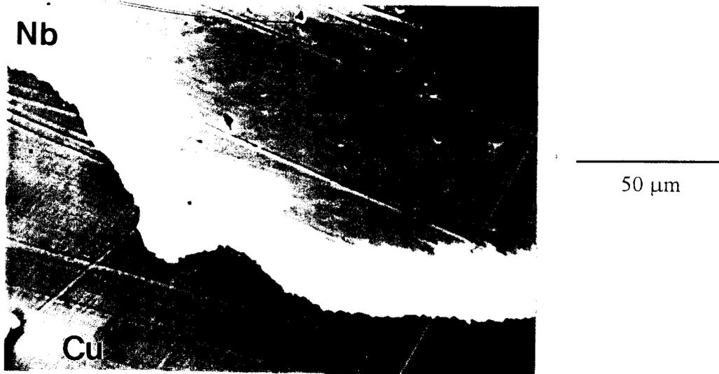
*Figure VII-8:* Déformation hétérogène de la barrière au contact d'une pointe de NbTi
