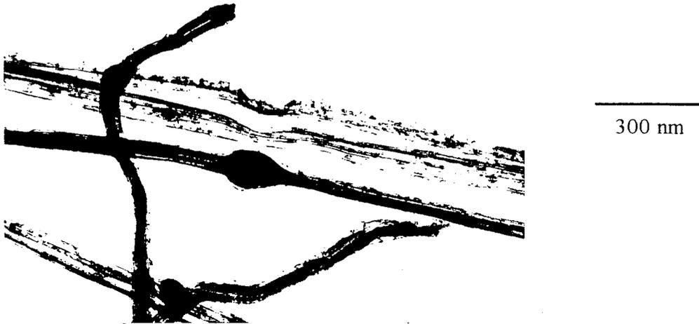
*Figure VI-12:* Aspect nodulaire des intermétalliques après traitement de mise en forme
