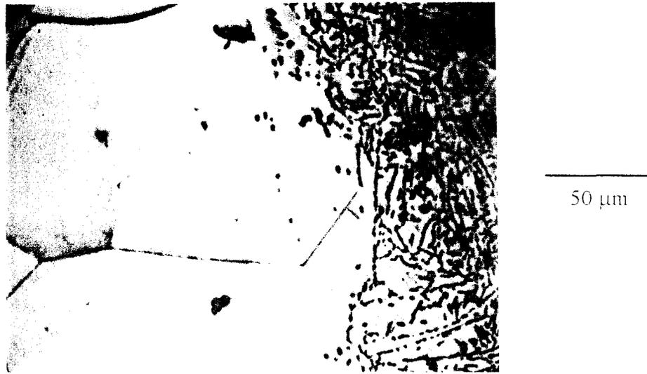
*Figure IX-5:* Microstructure du NbTi recuit 3h à 700°C sous vide primaire
