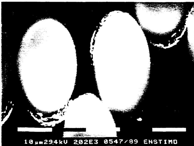
Fig.120: Décohésion à l'interface fibre/matrice - Tube verre/époxy III
