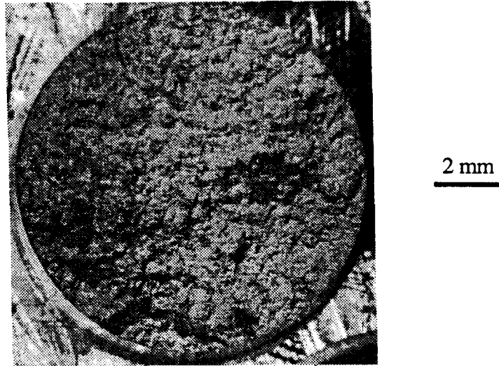
Figure III.10 : Faciès de rupture en traction monotone du composite F3K10S, observé à la loupe binoculaire
