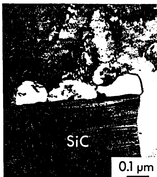
Figure I.38 : Croissance de vides à l'extrémité d'un whisker lors de la rupture d'une éprouvette de traction d'un composite 6061 + SiC w vieilli. [76]
