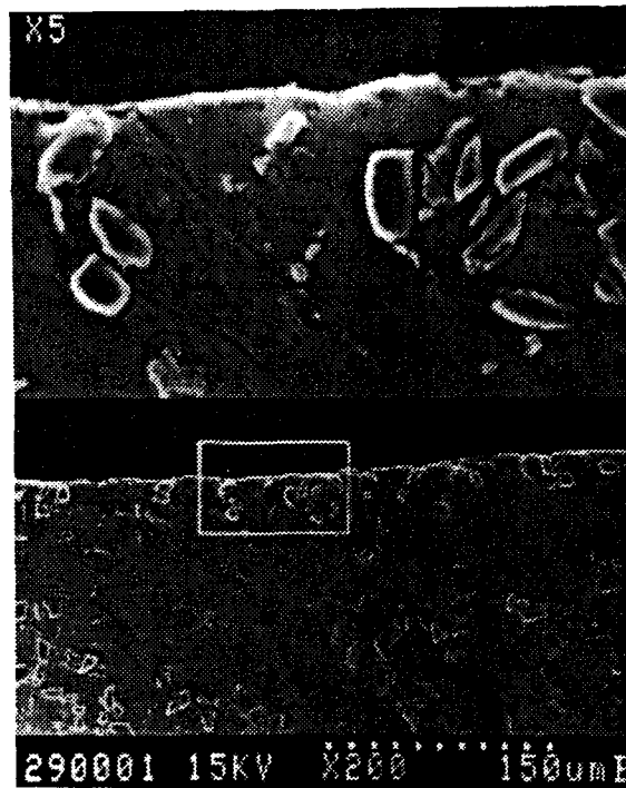
Figure IV.39 : Coupe longitudinale d'une éprouvette de composite F3K10S à l'état brut de fonderie (BF), au microscope électronique à balayage.
