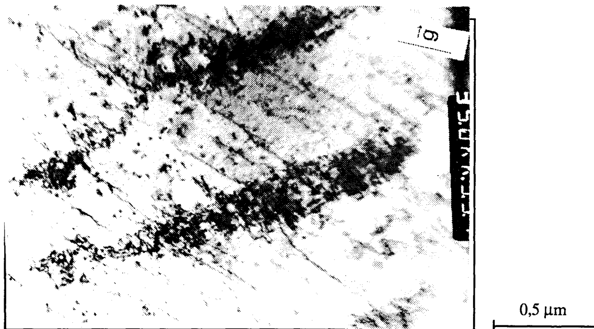
Figure III.36 : Structure "en parois" dans la phase ferritique de l'acier AF18, après cyclage jusqu'à 2000 cycles ( N_R \approx 4000 cycles) à \Delta\epsilon_t = 1,4 \% , ( \epsilon_{aps} \approx 0,43 \% ) ; axe du grain [0\ 2\ 3] , plan de la lame (\bar{2}\ \bar{1}\ 7) , \vec{g} = [\bar{1}\ 1\ 0] .
