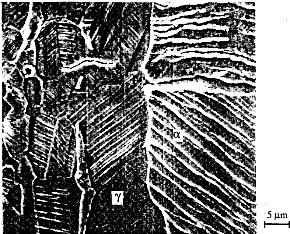
Figure III.19 : Bandes de glissement dans les phases ferritique et austénitique de l'acier AF18, à haut niveau de déformation ( \Delta\varepsilon_t = 2,5 \% ).
