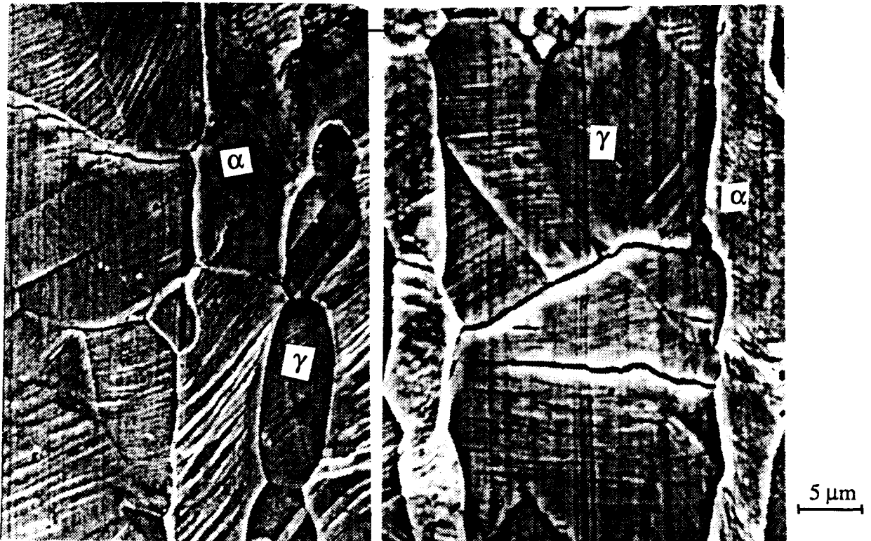
Figure III.24 : Amorçage intergranulaire des microfissures dans la phase austénitique, acier AF18, \Delta\epsilon_t = 2,5 \% .
