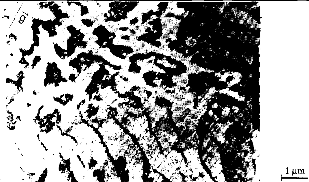
Figure III.33 : Structure "matrice" de dislocations (partie supérieure) et structure "parois" (partie inférieure), dans la phase ferritique de l'acier AF11, après cyclage jusqu'à 2600 cycles ( N_R \approx 4500 cycles) à \Delta\epsilon_t = 1,4\% , ( \epsilon_{aps} \approx 0,45\% ), \vec{g} = \langle 2\ 0\ 0 \rangle .
