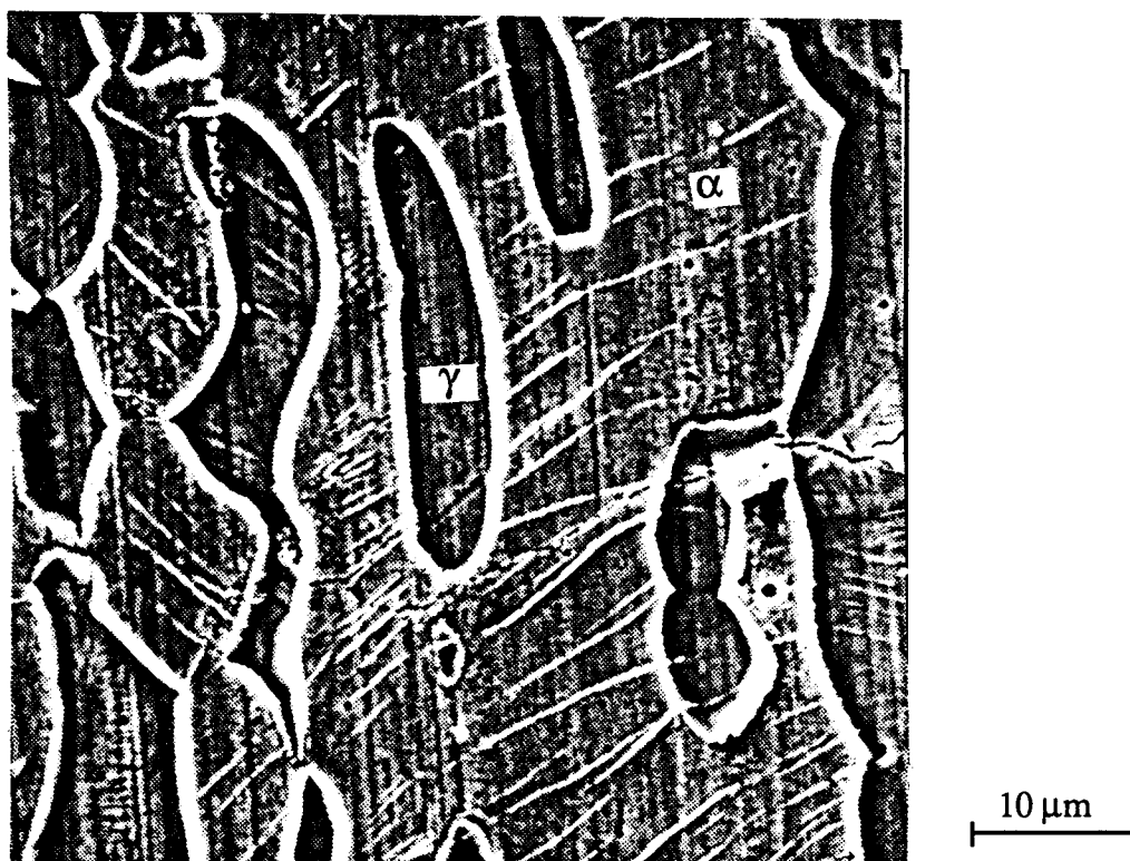
Figure III.16 : Bandes de glissement dans la phase ferritique de l'acier AF11, à bas niveau de déformation ( \Delta\varepsilon_t = 0,8 \% ).
