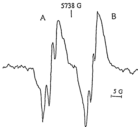
Figure 29: Spectre du radical OH (raies A et B) obtenu à 4 \cdot 10^{-2} Torr dans une flamme \text{CH}_4/\text{O}_2/\text{N}_2 ( \Phi = 1,016 ; P=80 Torr).
