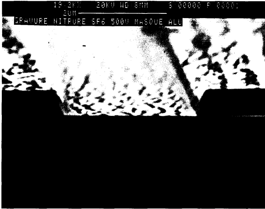
Fig.V-6 : Profil de gravure du nitrure de silicium (5000Å) au plasma SF 6 avec un masque aluminium (500Å) tension continue de 500V. (pression 50mT, 95sccm)
