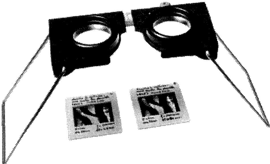
Figure 5.8: Un stéréoscope. Chaque oeil regarde l'image correspondante (image gauche ou droite) à travers une loupe qui renvoie l'image à l'infini. L'observateur a ainsi l'illusion de regarder la scène 3D originale.
