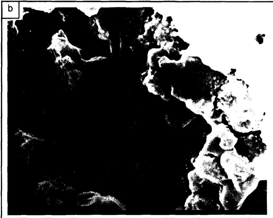
Figure III-21: Exemple de sous-structure  $T=100^{\circ}\text{C}$   $P=7\text{MPa}$   $0\% \text{CaCO}_3$
