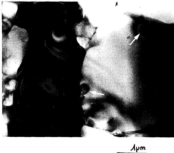
Figure VI.7 : Effets viscoélastiques,, Fluage à 1650°C sous 80 MPa, \epsilon = 8\% .
