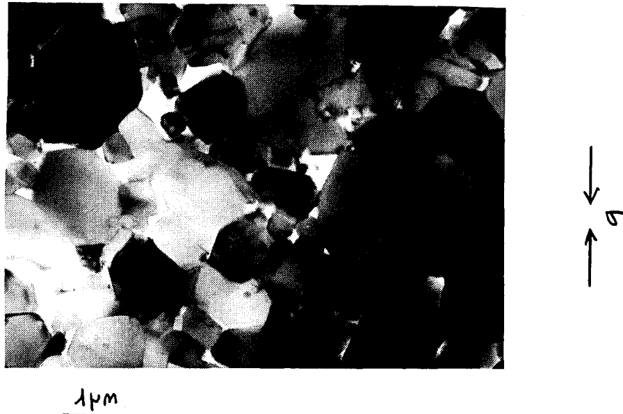
Figure VI.3 : décohésion des grains à 1600^\circ\text{C} , \dot{\varepsilon}_0 = 2.10^{-5}/\text{s} , \varepsilon = 3 \% , \sigma_{\text{max}} = 450 \text{ MPa} .
