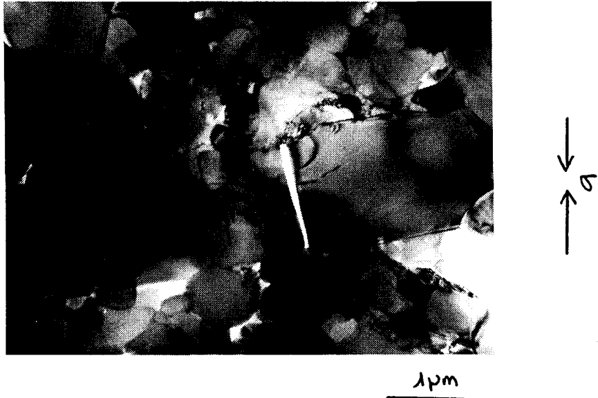
Figure VI.4 : Rupture intragranulaire à 1600°C, \dot{\epsilon}_0 = 2 \cdot 10^{-5}/s , \epsilon = 3\% , \sigma_{\max} = 450 MPa.
