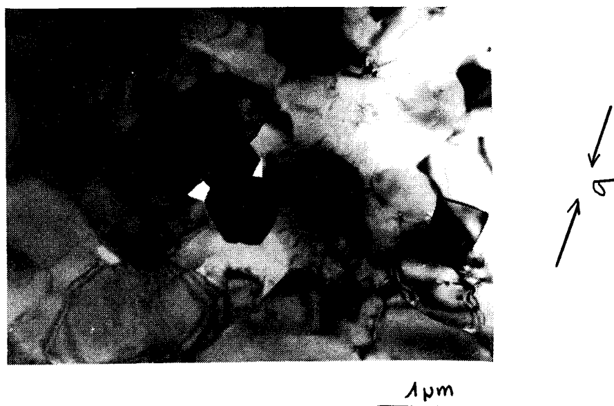
Figure VI.18 : Rares cavités observées dans le stade II de déformation, ( 1643^{\circ}\text{C} , \dot{\epsilon}_0 = 1,38 \cdot 10^{-6}/\text{s} , \epsilon = 39\% , t = 2350 \text{ min} , \sigma_{\text{maxi}} = 23 \text{ MPa} ).
