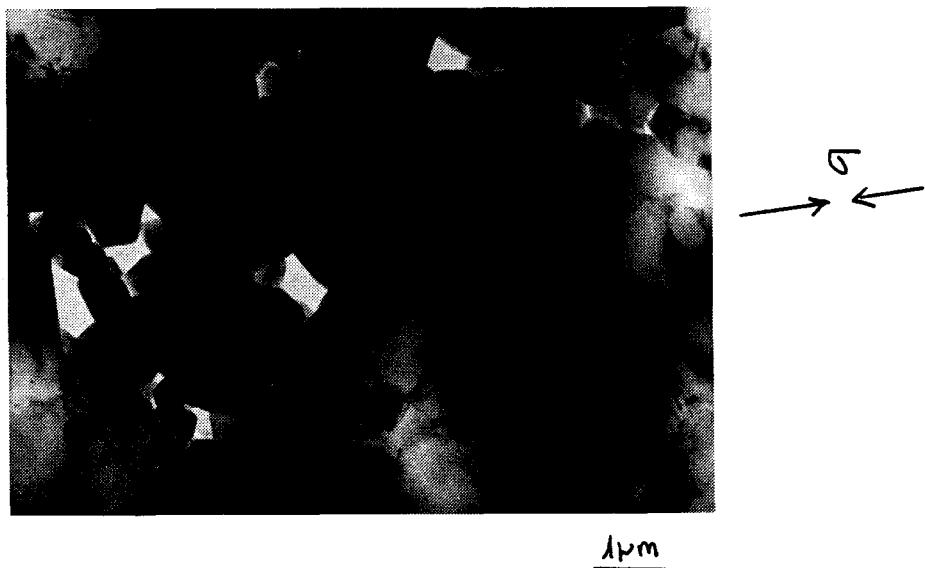
Figure VI.2 : Fluage à 1650°C sous 80 MPa, \varepsilon = 8\% .
