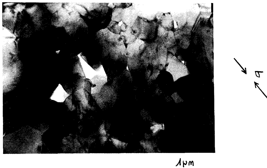
Figure VI.19 : Endommagements observés au passage vers le stade III de la déformation. ( 1695^{\circ}\text{C} , \dot{\epsilon}_0 = 1,2 \cdot 10^{-5}/\text{s} , \epsilon = 39\% , t = 475 \text{ min} , \sigma_{\text{maxi}} = 80 \text{ MPa} ).
