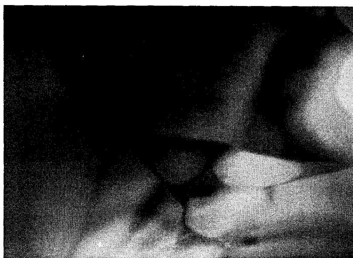
Figure VI.15 : Poches de phases vitreuses après déformation (1643°C, \dot{\epsilon}_0 = 1,38 \cdot 10^{-6}/s , \epsilon = 39\% , t = 2350 \text{ min} , \sigma_{\text{maxi}} = 23 \text{ MPa} ).
