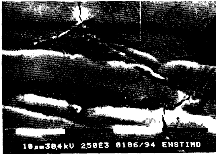
Fig. V-8 : Amorçage des fissures à faible niveau de déformation ( \Delta\epsilon_p/2 = 5 \cdot 10^{-4} , \epsilon = 10^{-2} s^{-1} ).
