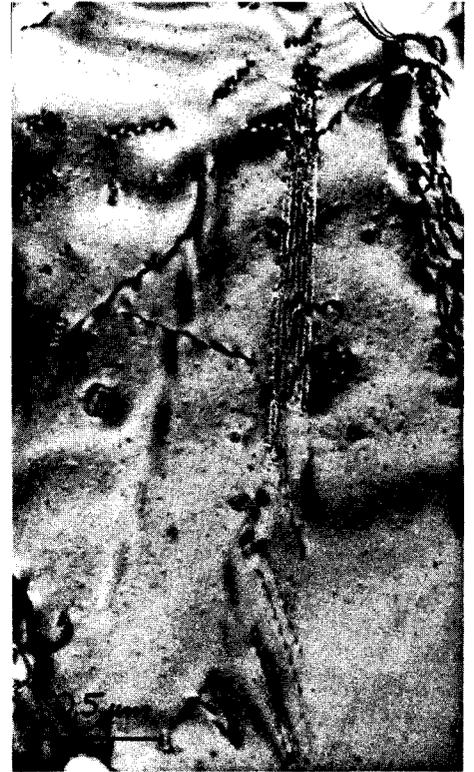
Figure 9: Bidart - (a) Bandes de dislocations dans  $(10\bar{1}3)$  et petites bulles de fluides. (b) Fines tranches de macle mécaniques basales avec des dislocations partielles dans les parois (champs clairs).
