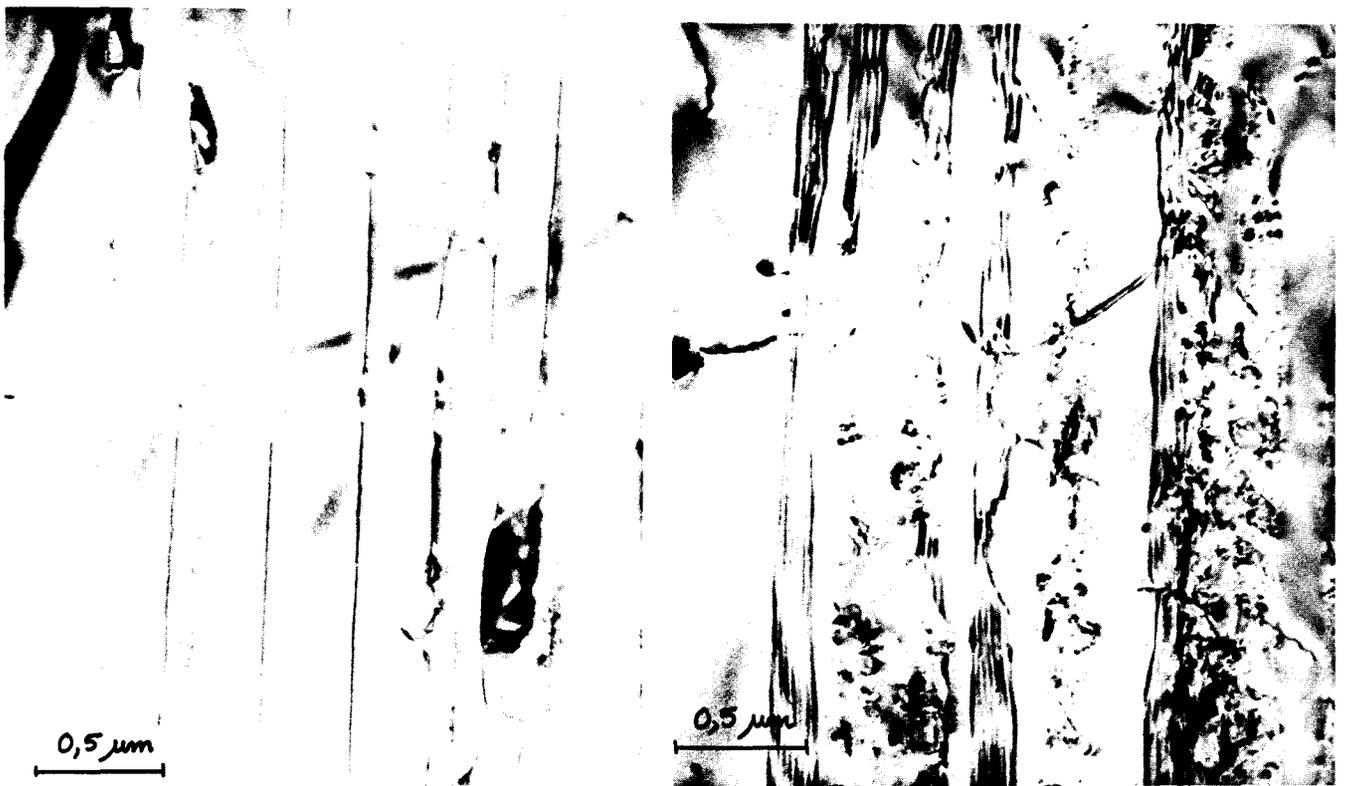
Figure 11: Popigai (échantillon choqué à 20-25 GPa) - (a) Fins PDF parallèles à  $(10\bar{1}3)$  vus de bout. Ils sont décorés de nombreuses petites bulles. (b) Les mêmes PDF inclinés par rapport au faisceau d'électrons. On remarque qu'un certain nombre d'entre eux présentent un contraste de franges irrégulières. Ces franges sont absentes si des inclusions fluides sont connectées sur le défaut, illustrant la recristallisation assistée par la présence de fluides (champs clairs).
