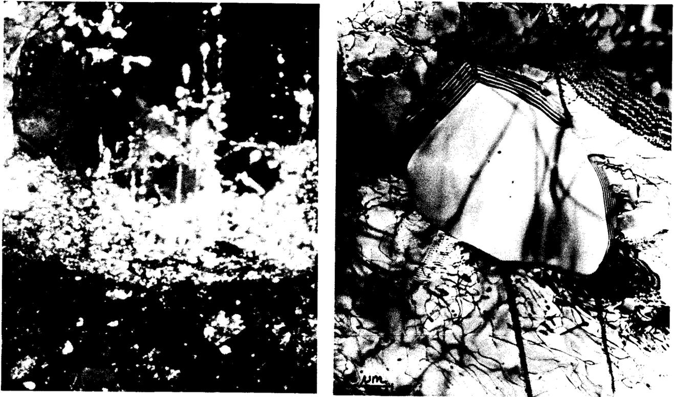
Figure 21: Vredefort (échantillon LK-4) - (a) Microscopie optique montrant un grain de quartz (Q) bordant une veine pseudotachylite (Pt). Noter la zone de recristallisation à l'interface et le long de défauts plans dans le quartz (lumière polarisée). (b) Grain de quartz recristallisé, connecté à une macle mécanique dans le plan de base (vue de bout) (champ clair,  $g=0003$ ).
