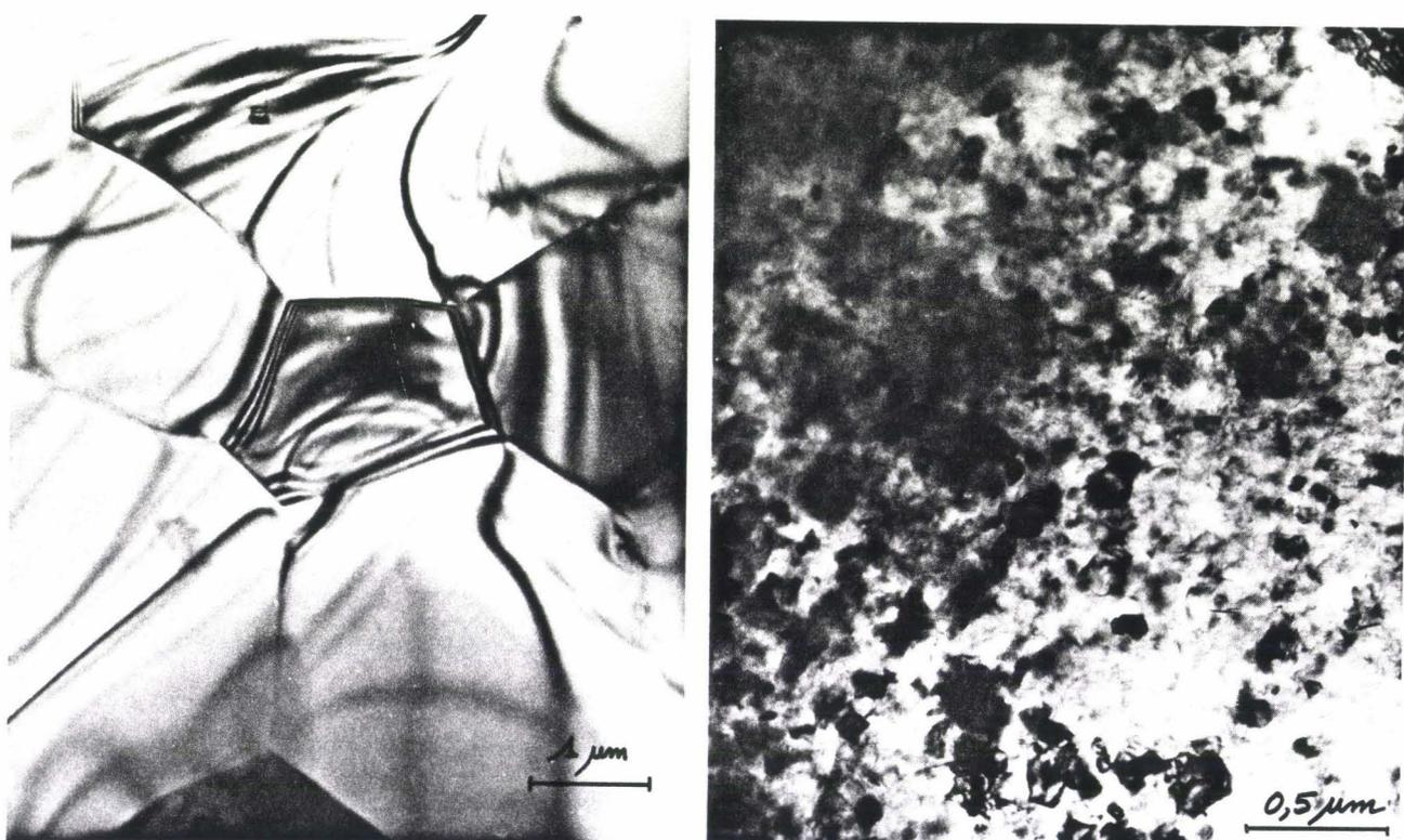
Figure 22: Vredefort (échantillon LK-4) - (a) Zone polycristalline le long d'une veine de pseudotachylite. Les grains sont équants avec des angles de  $\approx 120^\circ$ , ce qui indique une texture d'équilibre bien recristallisée. (b) dans la veine de pseudotachylite la recristallisation a produit de très petits cristaux ( $\approx 1000 \text{ \AA}$ ), probablement recristallisés à partir d'une phase amorphe (champs clairs).
