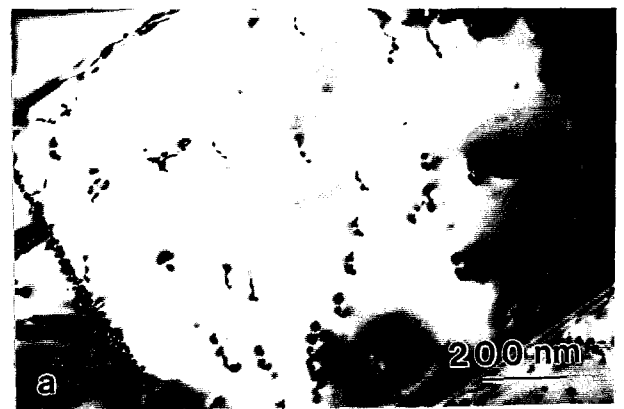
Figure 5.4 : Observation de la microstructure de déformation des alliages biphasés à température ambiante (après 3% de déformation), (a) dans la structure lamellaire, (b) dans les grains monophasés \gamma de la structure bimodale.
