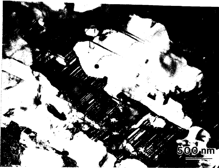
Figure 3.25 : Observation de domaines lamellaires au milieu des domaines de phase \gamma_m . L'ensemble des domaines lamellaires issus d'une même grain \alpha possède une orientation unique.
