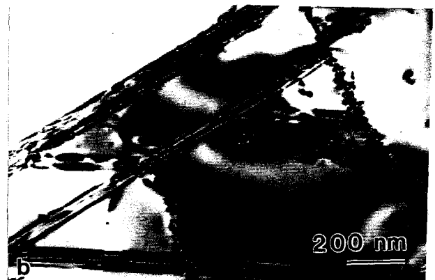
Figure 5.6 : Observation des modes de déformation activés dans les différents domaines \gamma de la structure lamellaire, (a) le domaine de référence présente essentiellement des dislocations simples a/2\langle 110 \rangle , (b) le domaine d'ordre voisin présente deux systèmes de macles simultanés.
