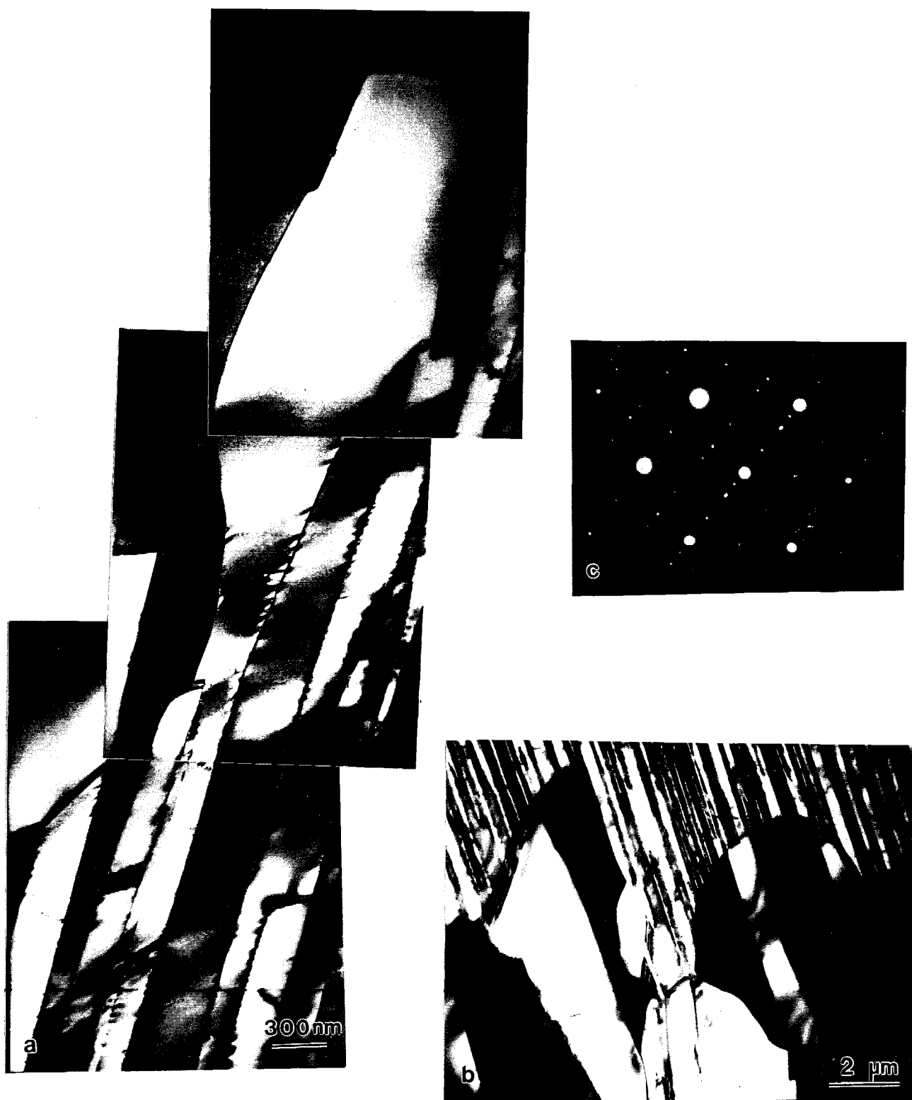
Figure 3.14 : Observation du développement de la croissance discontinue en MET, sur l'alliage Ti_{54}Al_{46} maintenu 24 heures à 1150^{\circ}C : (a) évolution d'une lamelle, (b) formation de cellules lamellaires en tête du front de réaction, (c) la relation d'orientation entre les deux phases est conservée.
