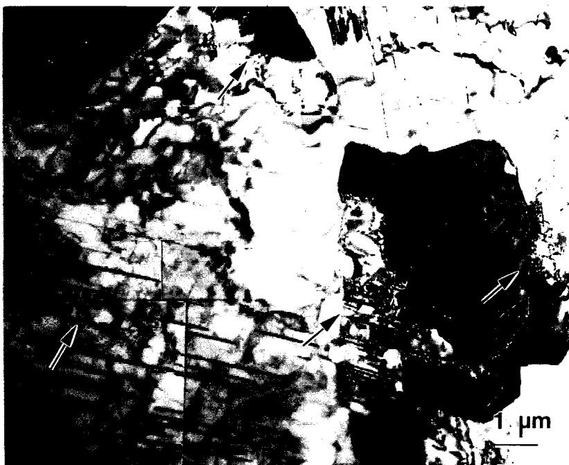
Figure 3.26 : Observation en MET de la phase \gamma_m .
