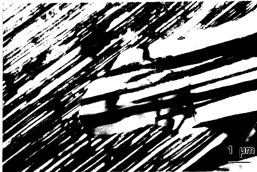
Figure 4.20 : Observation en MET des joints de grains dentelés des structures lamellaires à l'état brut d'élaboration.
