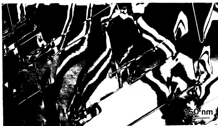
Figure 3.28 : Présence simultanée de fautes d'empilement et de parois d'antiphase dans la phase \gamma_m , donnant lieu à une configuration complexe des défauts plans.
