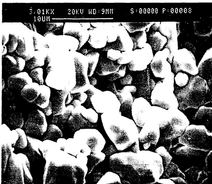
Figure 7 : Fractographies d'une céramique obtenue sur la ligne 3 pour  $x = 0.04$
