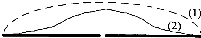
Figure 3-26 : Allure de la distribution du courant sur une antenne demi-onde
