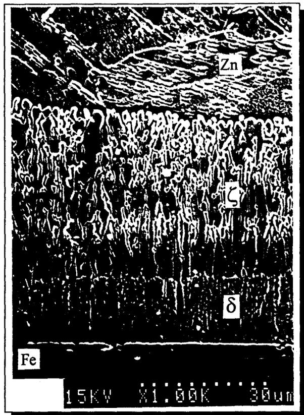
Photo P3.1 : Intermétalliques dans le cas d'un galvanisé à façon (450°C, 5 mn, Zn Z9 saturé en Fe)
