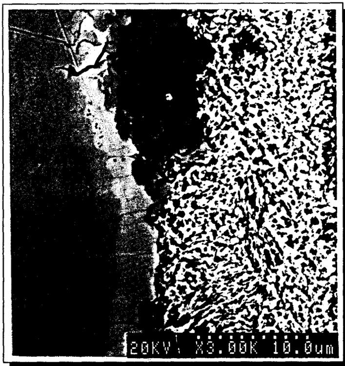
**Photo P3.26 :** Acier galvanisé à partir d'une poudre alliée Zn-Al à 5% massique d'Al
