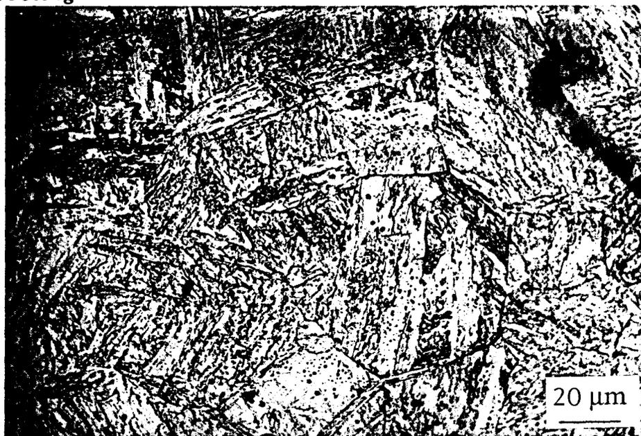
*Figure II-13 : Micrographie optique obtenue dans le matériau N-Si après le traitement d'austénitisation à 1150°C pendant 1/2 h suivi d'une trempe à l'air*
