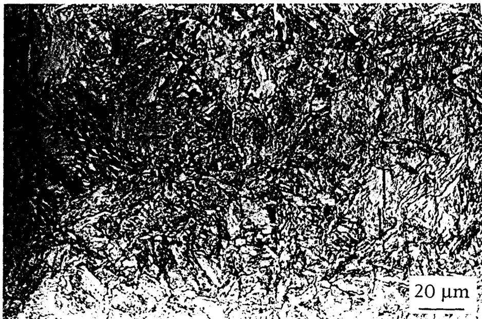
*Figure II-12 : Micrographie optique obtenue dans le matériau N après le traitement d'austénitisation à 1050°C pendant 1/2 h suivi d'une trempe à l'air*
