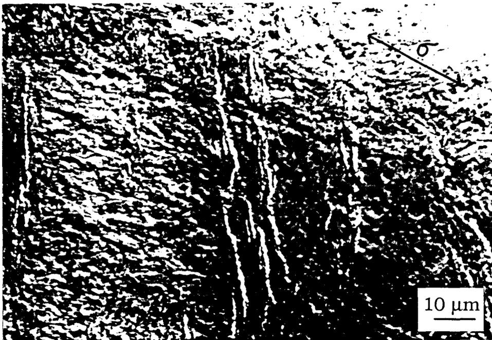
*Figure III-17 : Endommagement en surface après rupture de l'acier C-Si à  $\Delta\varepsilon_t=0.6\%$  : longues extrusions isolées -  $T=300\text{ K}$*
