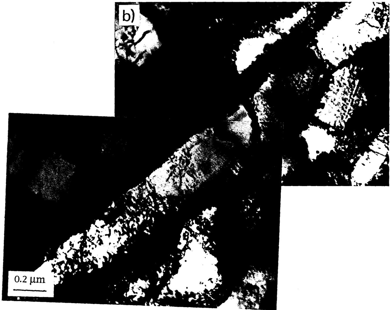
*Figure IV-5 : Structure de dislocations dans l'acier N-Si cyclé à rupture à  $\Delta\varepsilon_f=1.6\%$  : b) Condensation de dislocations sur les joints des lattes les plus étroites -  $T=300\text{ K}$*
