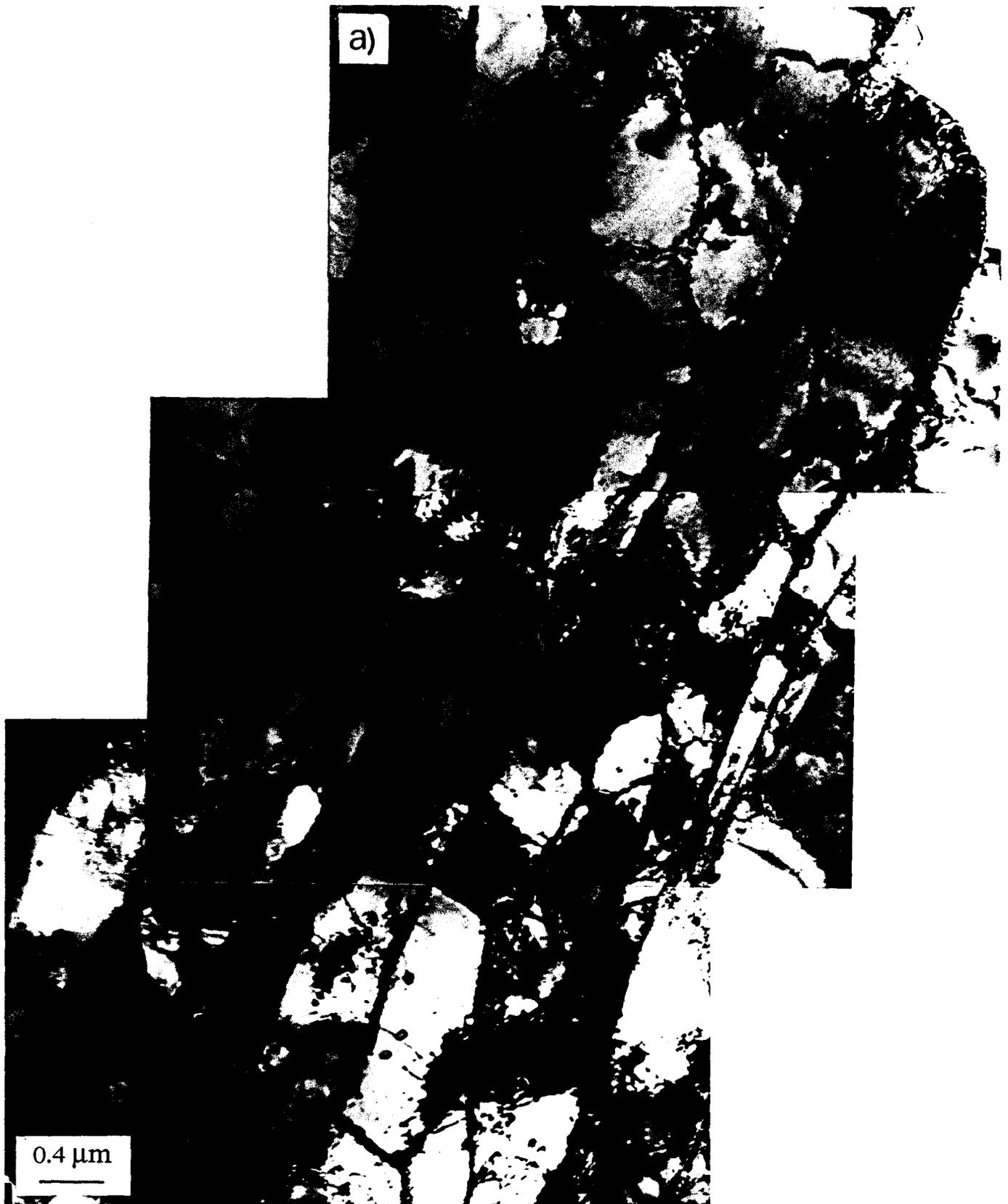
*Figure IV-5 : Structure de dislocations dans l'acier N-Si cyclé à rupture à  $\Delta\varepsilon_f=1.6\%$  : a) Cellules plutôt bien formées contenant une forte densité de dislocations -  $T=300\text{ K}$*
