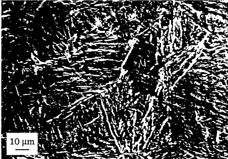
*Figure III-20 : Endommagement en surface après rupture de l'acier C-Si à  $\Delta\varepsilon_t=1.6\%$  : Longues extrusions et courtes extrusions regroupées en paquets -  $T=300\text{ K}$*
