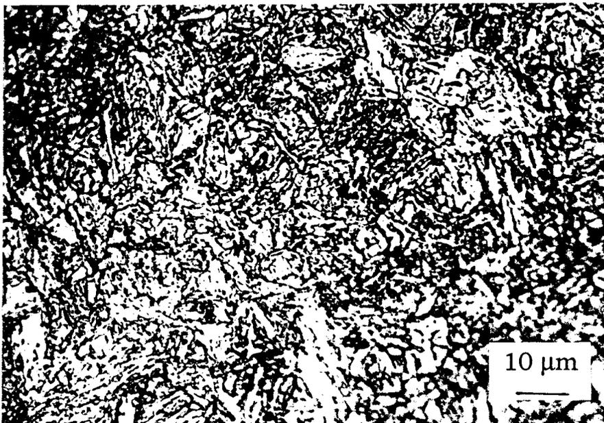
*Figure II-23 : Micrographie optique après le traitement (aust. 1050°C, revenu 500°C) dans l'acier N*
