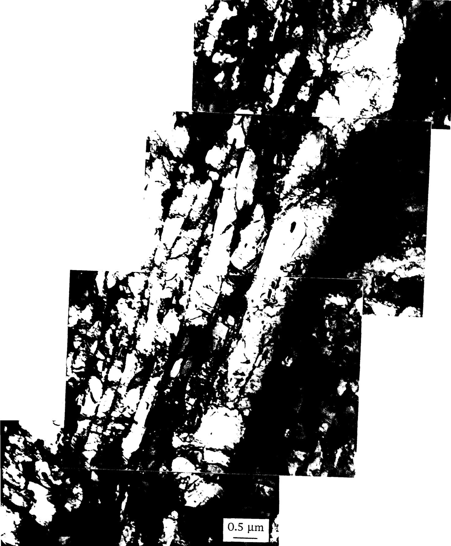
*Figure II-28 : Grandes îlots de ferrite dans la martensite revenue de l'acier C-Si*
