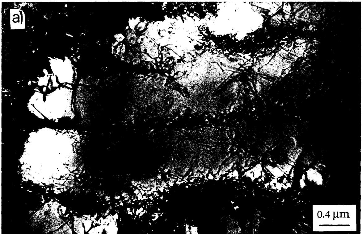
*Figure IV-1 : Structure de dislocations dans l'acier C-Si cyclé à rupture à  $\Delta\varepsilon_f=0.6\%$  : a) Murs dipolaires dans les îlots de ferrite -  $T=300\text{ K}$*
