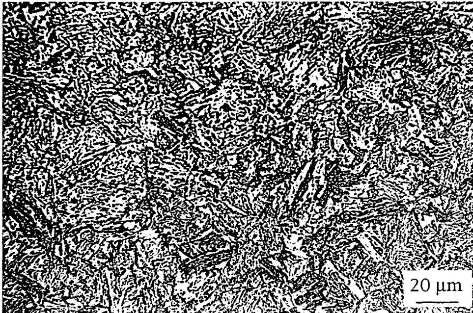
*Figure II-11 : Micrographie optique obtenue dans le matériau N-Si après le traitement d'austénitisation à 1050°C pendant 1/2 h suivi d'une trempe à l'air*
