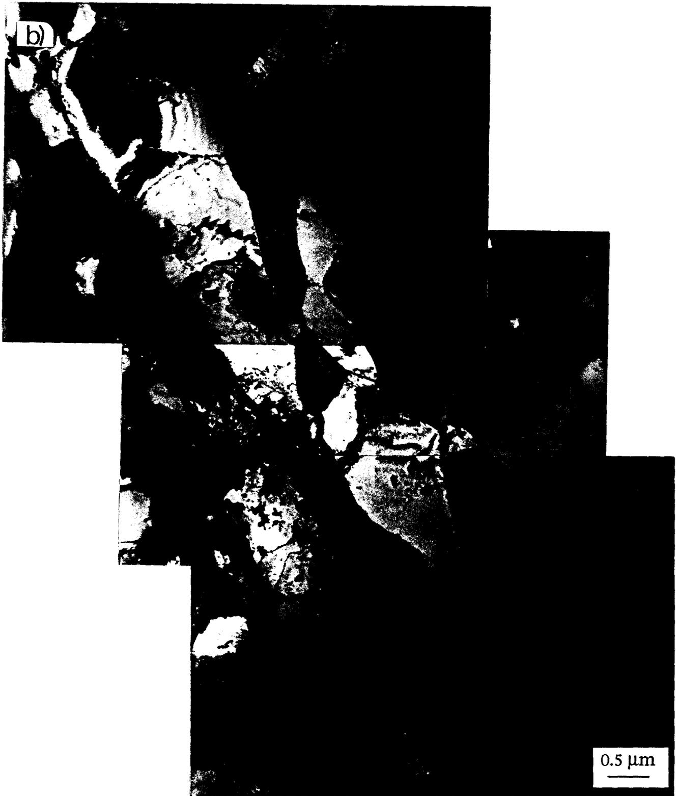
*Figure IV-1 : Structure de dislocations dans l'acier C-Si cyclé à rupture à  $\Delta\varepsilon_t=1.0\%$  : b) Arrangement cellulaire uniquement dans la ferrite -  $T=300\text{ K}$*
