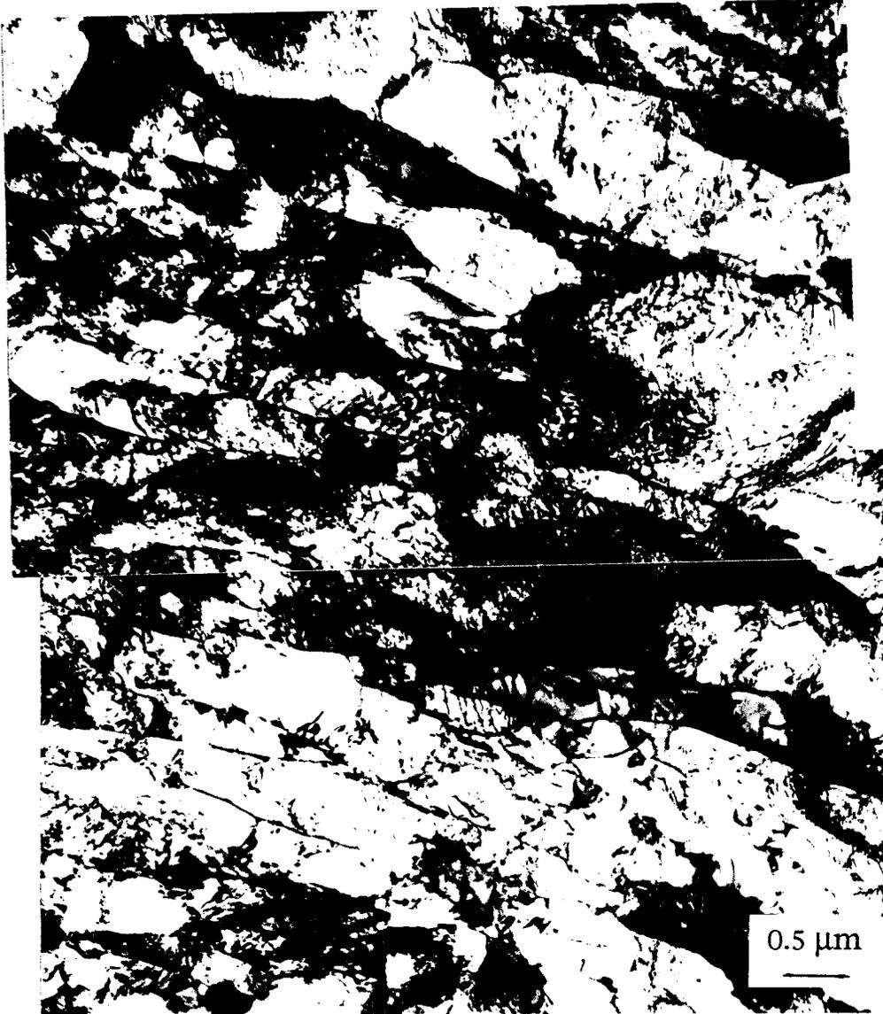
*Figure II-26 : Micrographie en transmission après le traitement de référence (aust. 1050°C, revenu 750°C) dans l'acier N*
