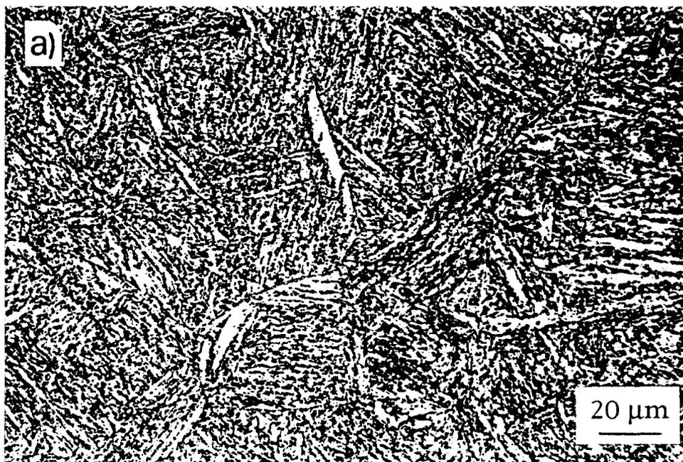
*Figure II-21 : Micrographie optique après le traitement de référence (aust. 1050°C, revenu 750°C) : a) dans l'acier C-Si*
