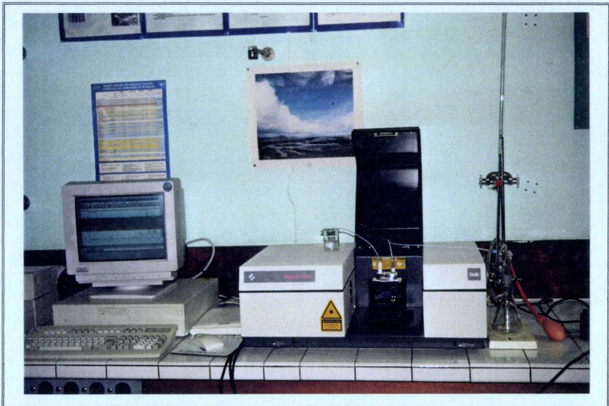
Figure 59 : Dispositif de mesure de diffusion par IRTF-ATR.
