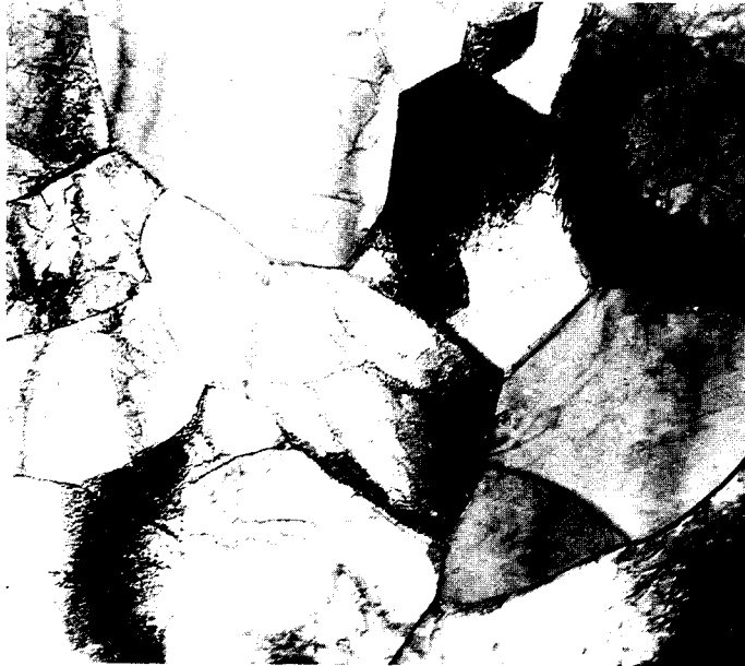
Photo n° 20' : XC10 - 270°C/s X9000 (Polygonisation: mélange de grains, de tailles différentes, plus ou moins écrouis)
