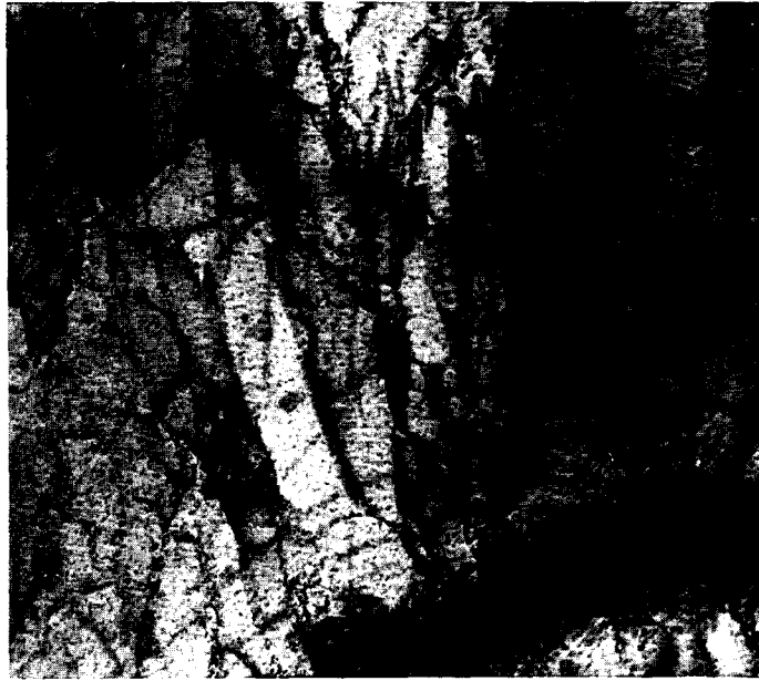
Photo n° 8' : XC10 - 270°C/s X22000 (Formation de sous grains dans la ferrite déformée)
