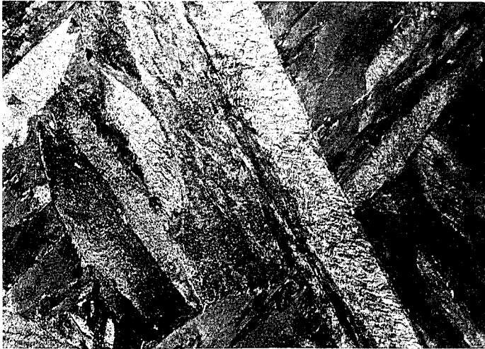
Photo n° 27' : XC38 - 10°C/s X12000 (Martensite en lattes)
