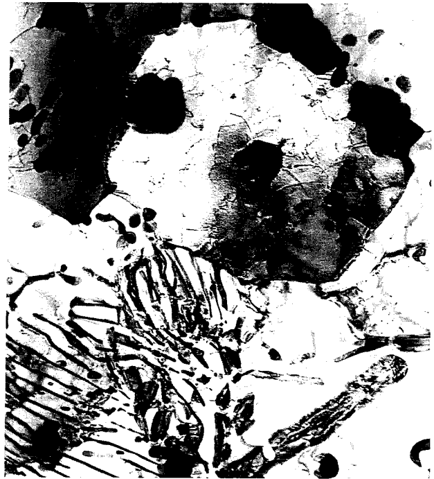
Photo n° 23' : XC100 - 10°C/s X9000 (Cémentite globulaire et lamellaire sur fond de ferrite)
