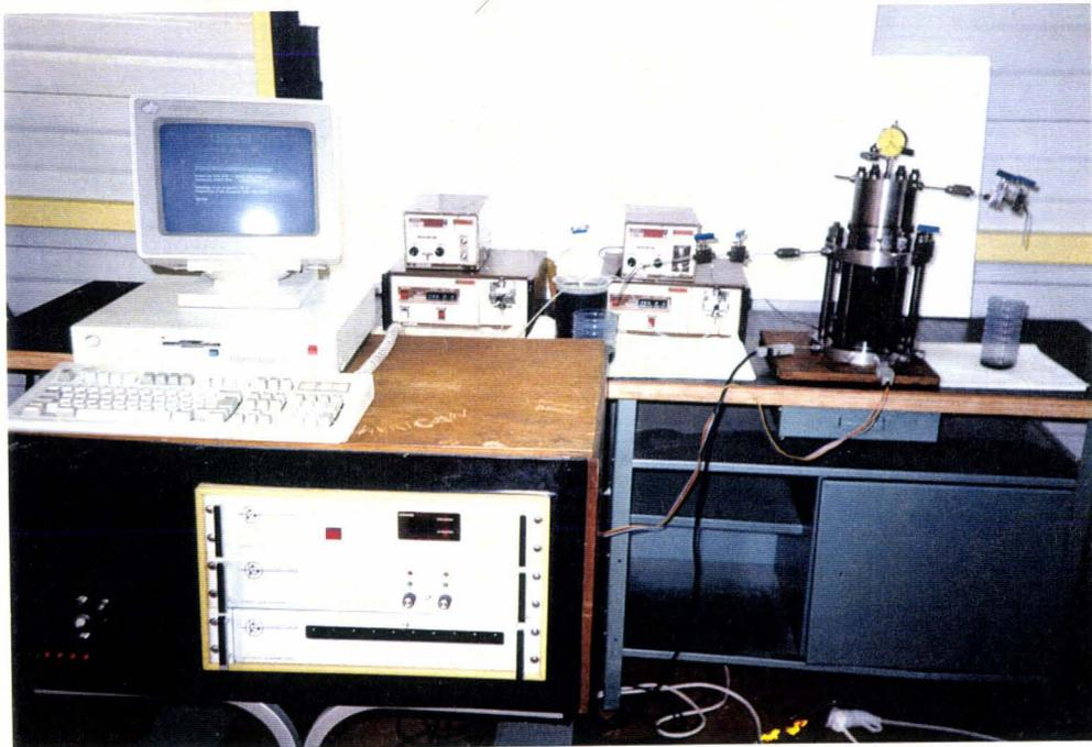
La cellule autonome et autocompensée et le système d'acquisition de données
