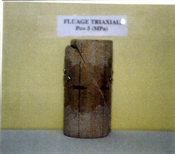
Echantillon sain, échantillon gainé avec des fils de jonction des jauges et échantillons rompus dans les différents essais
