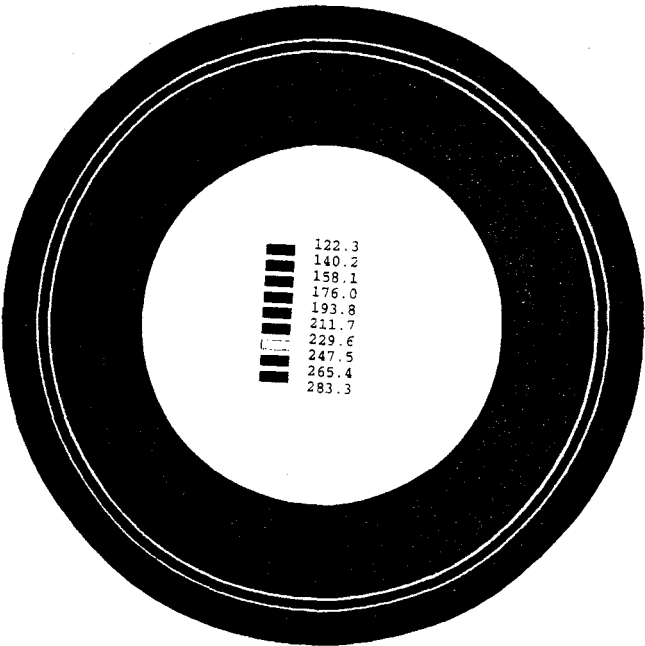
FD160 - Distribution numérique à t=22.5s \theta_{\max}=283^{\circ}\text{C} sur R=280mm
