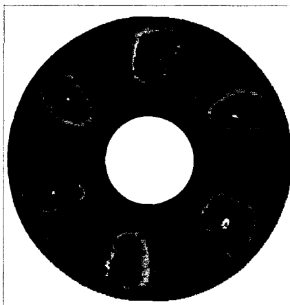
Fig. 100 - Thermographie de points chauds ( \theta_{\max} = 1013^{\circ}\text{C} )
