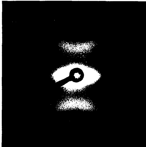
Figure VI-22-b: Cliché de diffraction des RX aux petits angles du PE-6 déformé à \epsilon_z \approx 4.0 , à 20°C.
