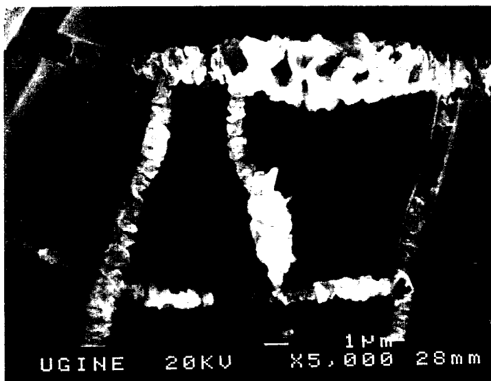
Figure 17 : Fissures du revêtement après introduction directe en étuve à 800^{\circ}\text{C} sous air (échantillon N°2) ; image obtenue en microscopie électronique à balayage (électrons secondaires), grandissement 5000.
