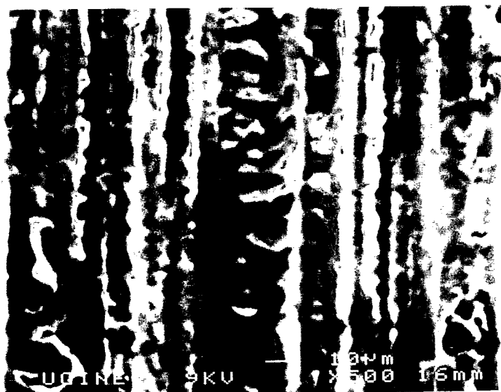
Figure 11 : Revêtement hybride MTES/PVP (30 %) après séchage sous cassette infrarouge ; image obtenue en microscopie électronique à balayage (électrons secondaires), grandissement 500.
