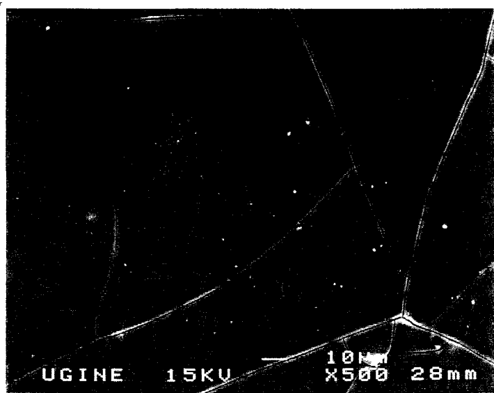
b) : Revêtement après séchage de 30 s sous cassette infrarouge.
