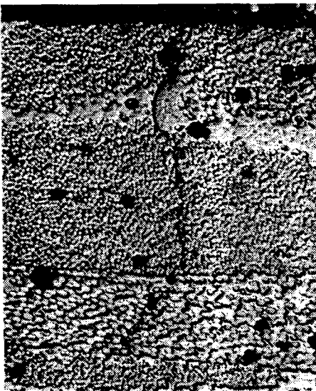
fig.4-14 - Fissures transverses - x 84 Découpe axiale - Côté top-coat - Génératrice extrados section F (cf.fig.3-1) - Vet 2355, chargement monotone croissant - Perlage à 129 bars
