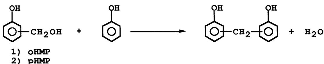
Il convient de vérifier, que ces réactivités préalablement établies peuvent être généralisées à tous les oligomères de la résine avec l'aide de cette autre réaction modèle (Schéma 3) :
