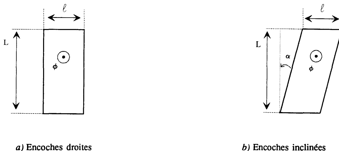
fig. II.12 : Variation de la section d'un tube de flux situé dans une dent rotorique
