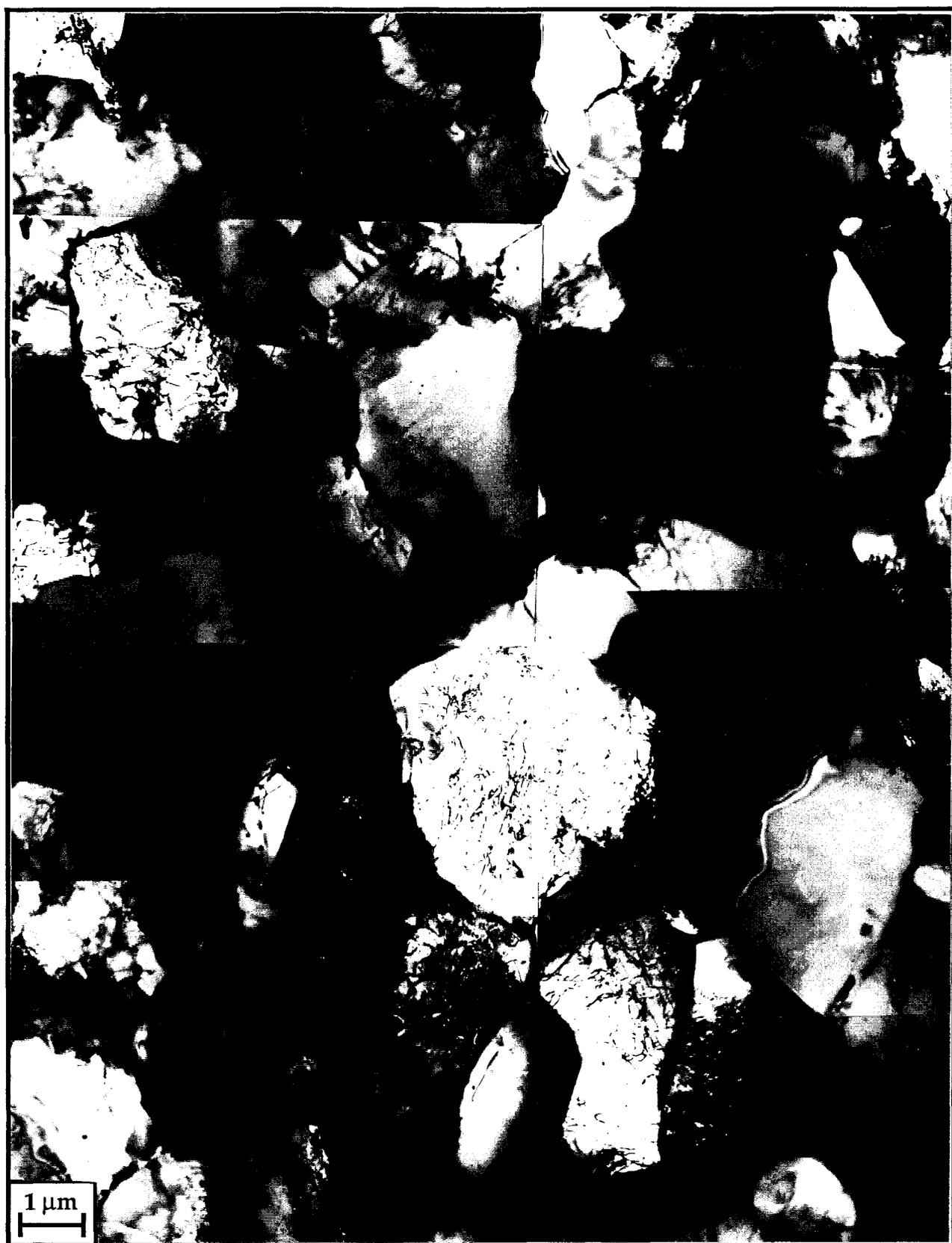
Figure 98: Microscopie électronique en transmission. Aspect de la matrice ferritique observée dans l'acier C aux TFR intermédiaires (450°C - 550°C) avec une vitesse de refroidissement  $V_{ry}$  de 25°C/s.
