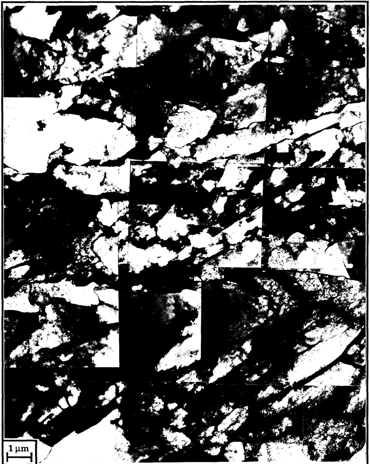
*Figure 100: Microscopie électronique en transmission. Aspect de la microstructure observée dans l'acier C aux basses TFR (< 350°C) avec une vitesse de refroidissement  $V_{ry}$  de 25°C/s.*
