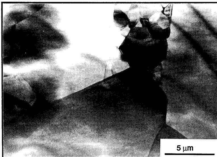
Figure 2-2 : Vue d'ensemble de la microstructure du spinelle.
