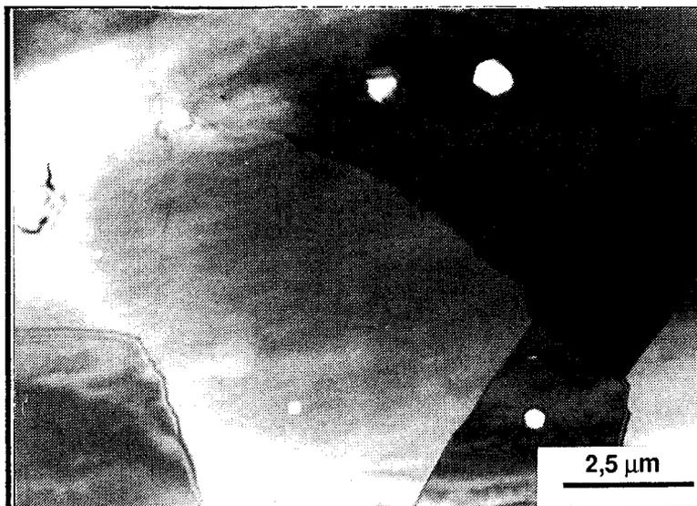
*Figure 2-5 : Vue d'ensemble de la porosité intragranulaire au cœur d'un point blanc.*
