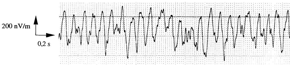
Figure 4.18 - Trace temporelle d'une composante horizontale du champ électrique
