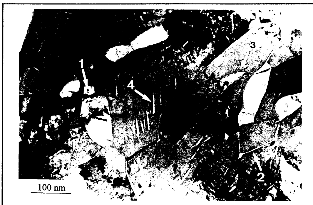
figure 18 Les quatre morphologies des particules de la phase \alpha (alliage Nb-Ti-Ta)
