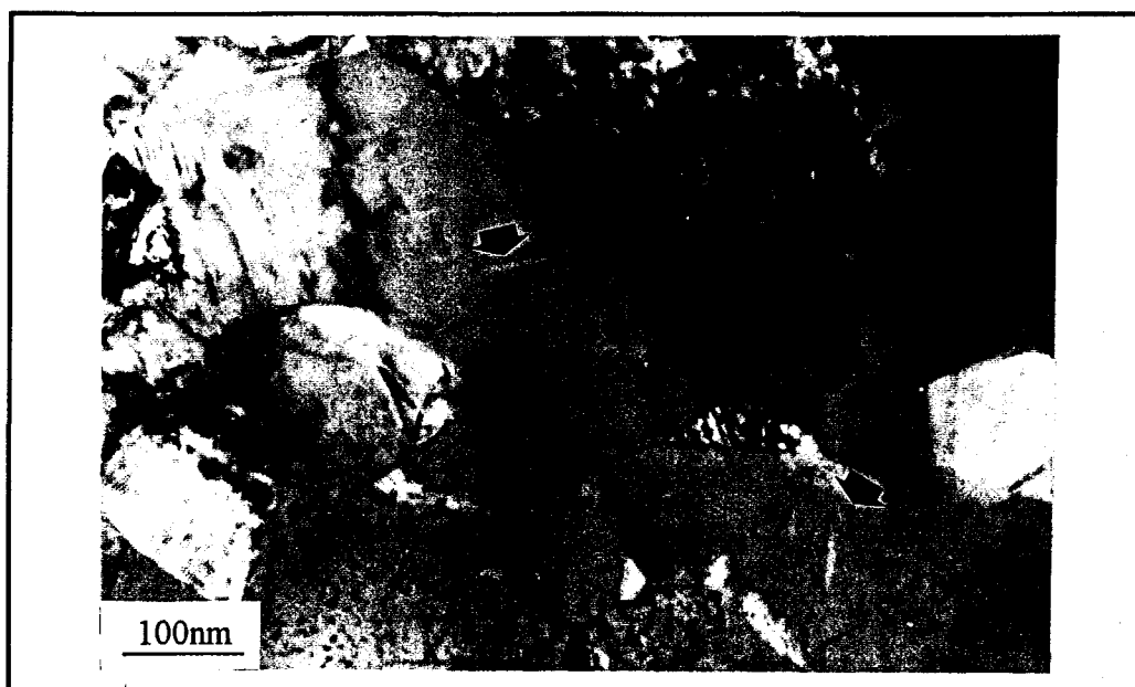
figure 47 Particules de la phase \alpha -Widmanstätten dans un échantillon de Nb-Ti vieilli 160h à 380°C.
