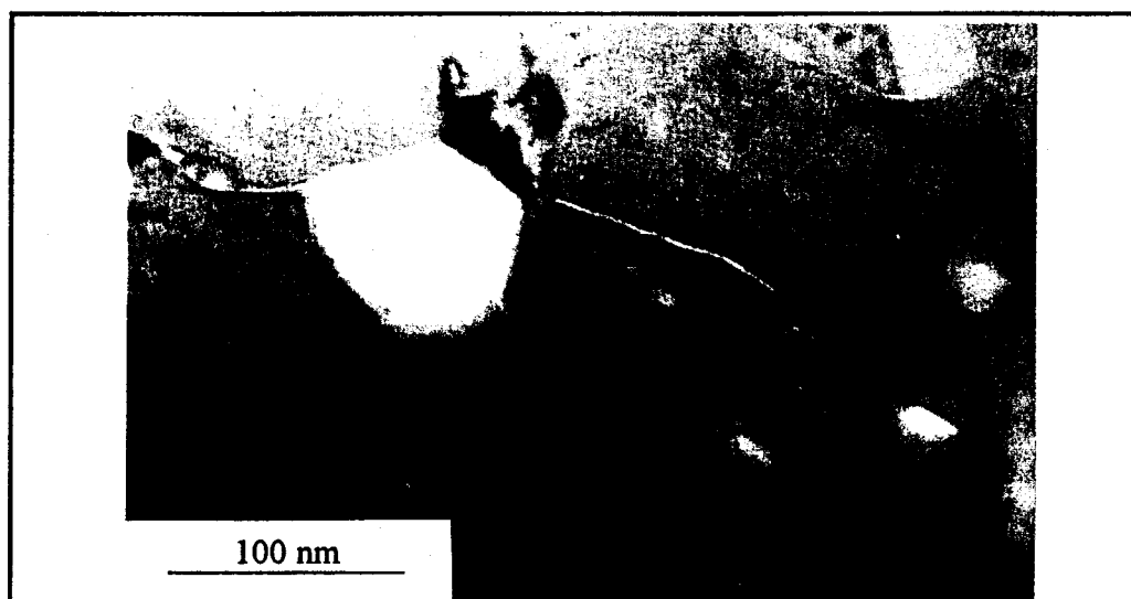
figure 36 Microstructure des filaments de Nb-Ti-25%Ta après le dernier TTh de la fabrication G.
