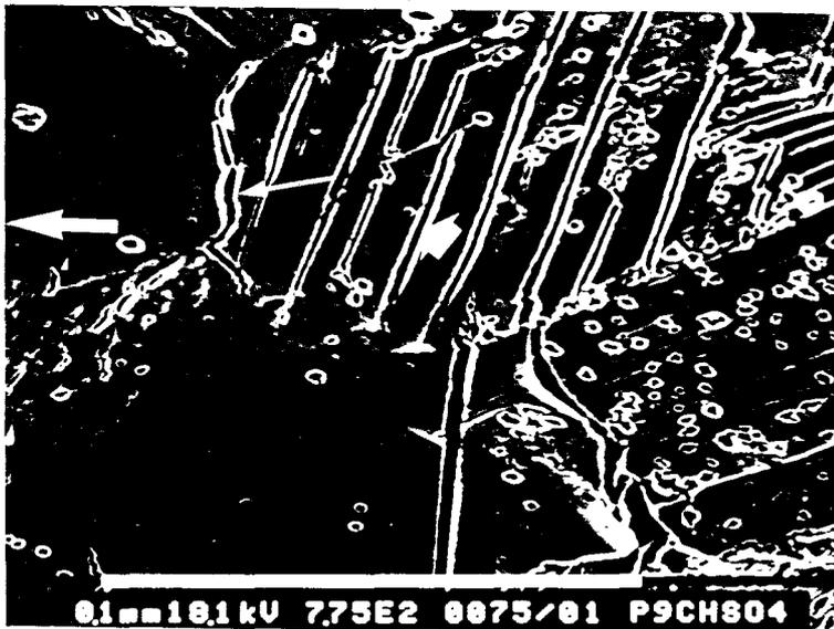
Fig.IV.20b. Fissures intergranulaires et transgranulaires s'amorçant dans les bandes de glissement et les joints de grain orientés approximativement perpendiculaires à l'axe de chargement. (Both intergranular and transgranular cracking initiate in slip bands and grain boundaries orientated roughly perpendicular to loading axis).
