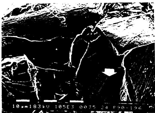
Fig.III.2. Présence de nombreuses traces de ligne de glissement sur une rupture fragile intergranulaire. (Presence of numerous slip-line traces on intergranular brittle surface fracture).
