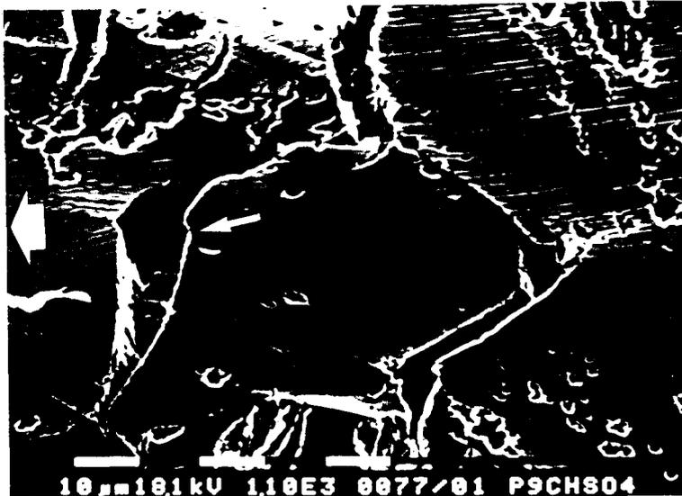
FigIV.20c. Fissures intergranulaires larges, profondes orientées approximativement perpendiculaires à l'axe de chargement, et apparence de nombreuses piqûres de corrosion intragranulaires. (Wide and deep intergranular cracking at grain boundaries oriented roughly perpendicular to the loading axis, and aspect of numerous intragranular corrosion pits).
