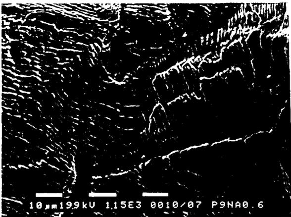
Fig.II.12. Aspect microscopique général de la zone de propagation : stries de fatigue observées à la température de la salle d'essais. (General microscopic aspect of propagation zone : striation-like features observed at room temperature).
