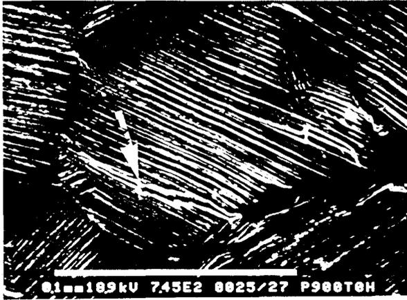
Fig.II.10b. Répartition homogène de la plasticité en surface et amorçage transgranulaire des fissures de fatigue dans les bandes de glissement (homogeneously reparted plasticity on the surface and transgranular crack initiation observed in slip bands ).
