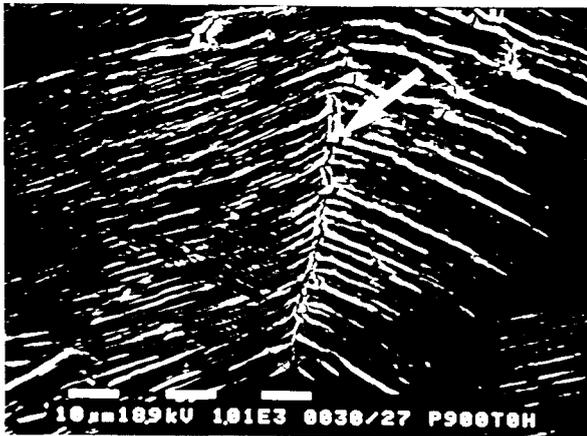
Fig.II.10c. Répartition homogène de la plasticité en surface et amorçage intergranulaire des fissures de fatigue (homogeneously reparted plasticity on the surface and intergranular crack initiation observed at the grain boundary ).
