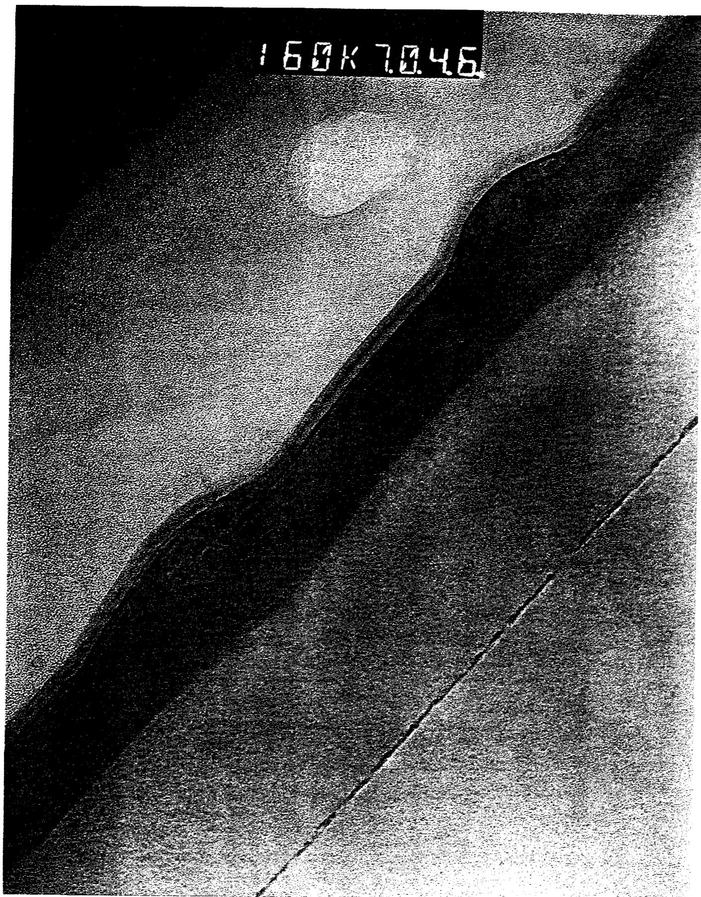
**Figure V-13.** Image TEM de l'alliage  $\text{Si}_{0.8}\text{Ge}_{0.2}$  oxydé 500 C. 1 cm représente 250 Å.
