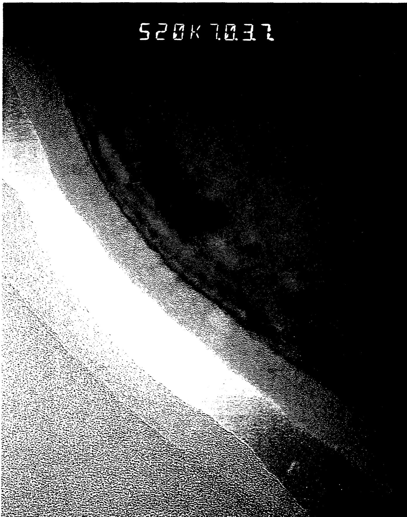
**Figure V-12.** Image TEM de l'alliage  $\text{Si}_{0.8}\text{Ge}_{0.2}$  oxydé à  $500^\circ\text{C}$ . 1 cm représente 77 Å.
