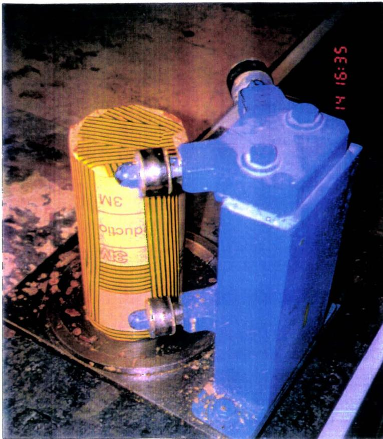
*Figure 2.2. - Papier de verre collé aux parois de l'éprouvette*
