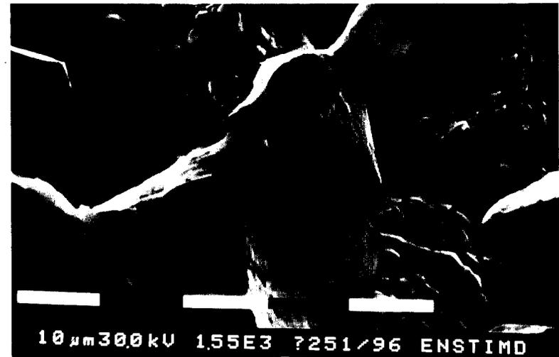
Echantillon F16BH53 (surface) : Faciès de rupture intergranulaire accompagnée de zone ductile - Zone A
