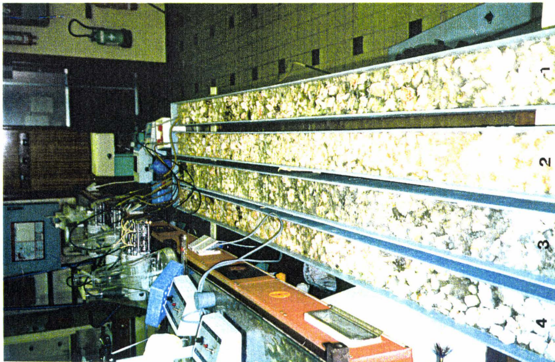
Planche 2 - Réacteurs de dénitrification à biofilms fixés et à flux horizontal
