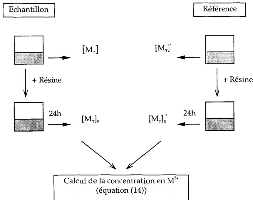
Figure 1. Protocole expérimental suivi pour définir la concentration en  $M^{2+}$  en solution.
