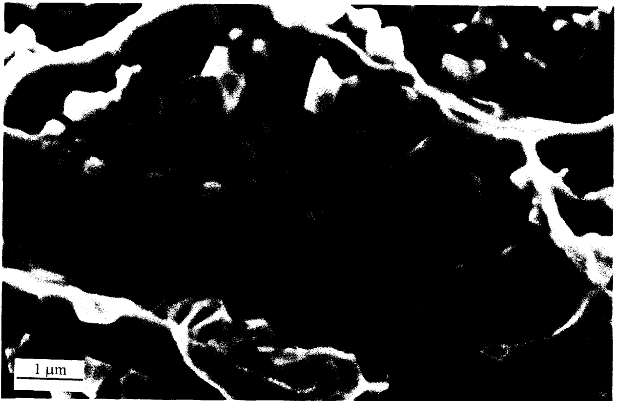
figure C-35: Faciès de rupture d'un brin allié au tantale (B / 96h/375°C + 24h/850°C).
