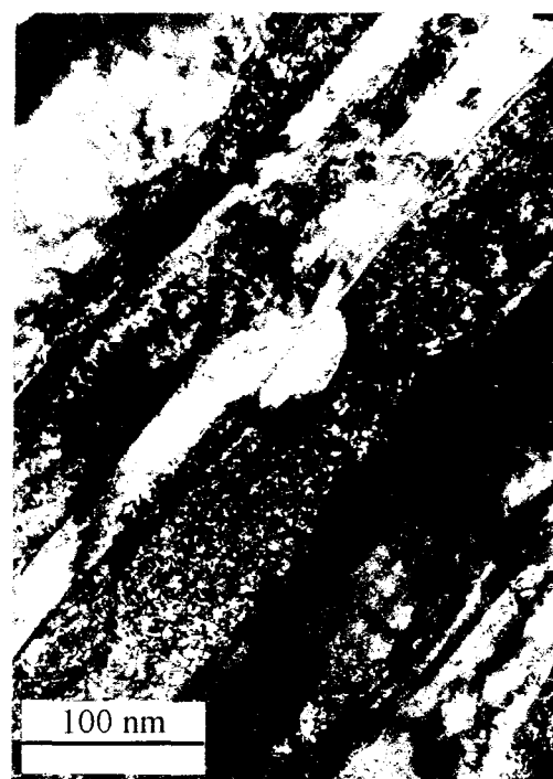
figure C-17: Micrographie du début de recristallisation d'un filament de Nb,Ta après 96h/340°C.
