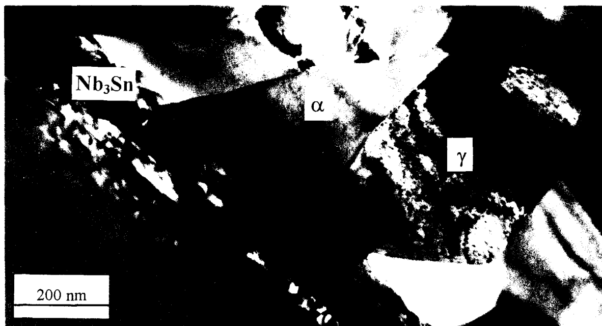
figure D-5: Microstructure du composé Nb 3 Sn en présence d'un bronze biphasé formé lors d'une montée de 6°C/h jusqu'à 550°C.
