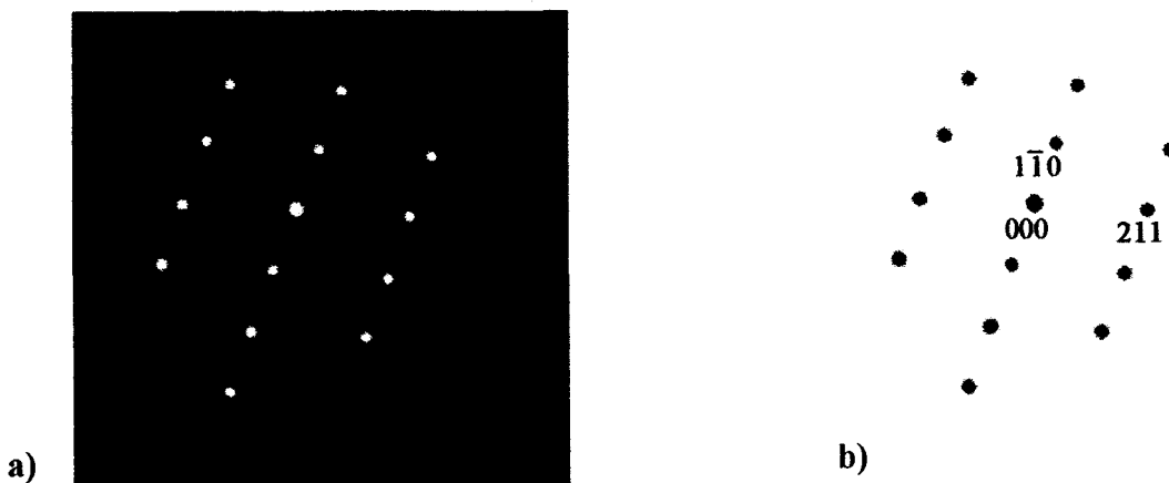
figure C-46: Cliché (a) de l'axe de zone [11\bar{3}] du grain de \text{Nb}_3\text{Sn} et son dépouillement (b).
