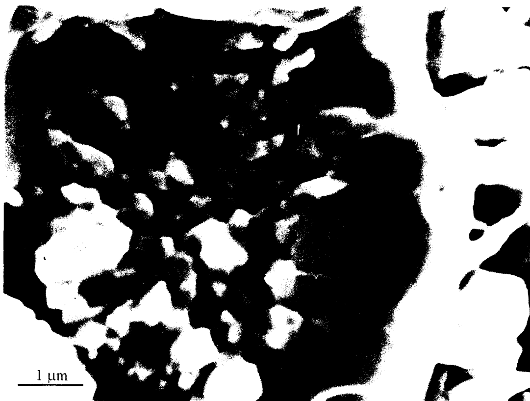
figure C-36: Faciès de rupture d'un brin allié au titane (C / 96h/375^{\circ}\text{C} + 24h/850^{\circ}\text{C} ).
